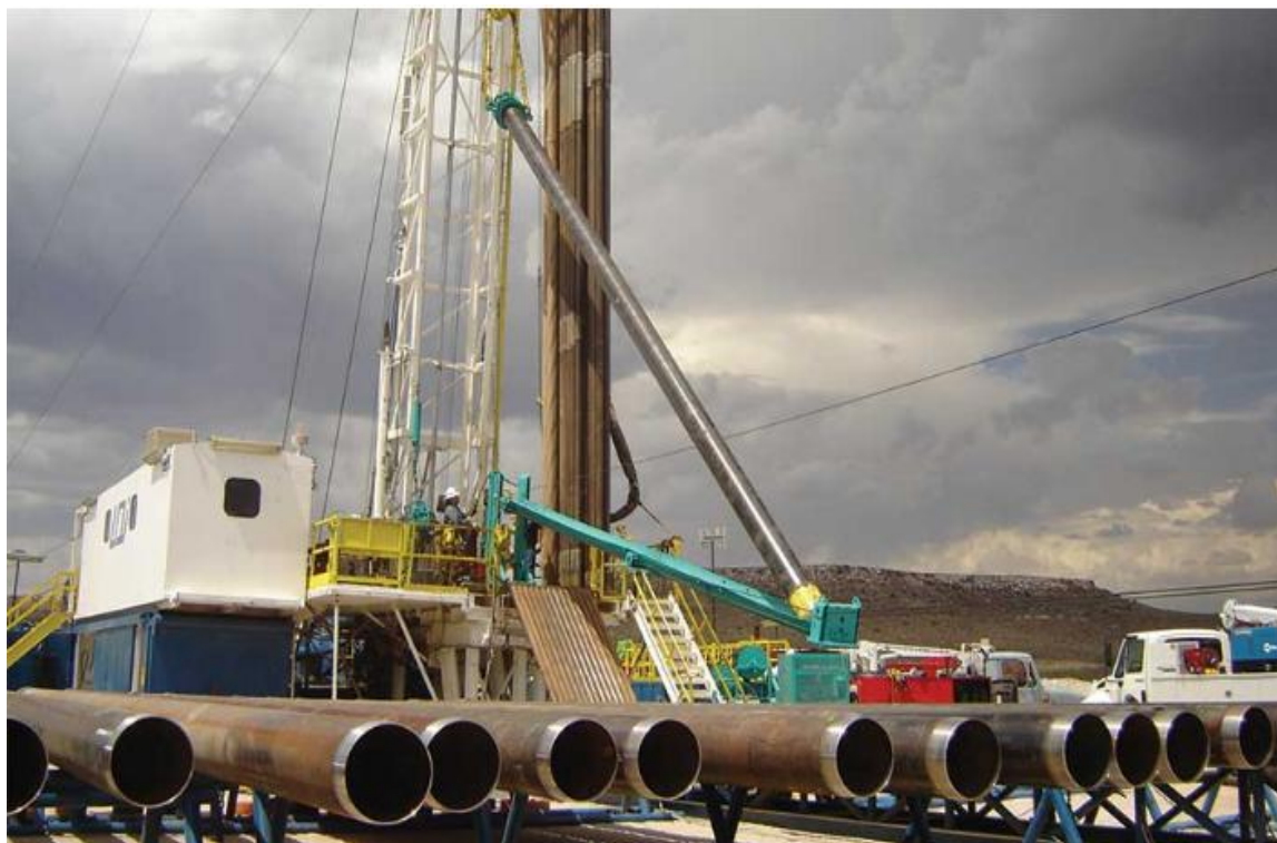
Εικόνα 1.5: Σωληνώσεις που θα χρησιμοποιηθούν για την επένδυση γεώτρησης (ALAMY, 2017).
