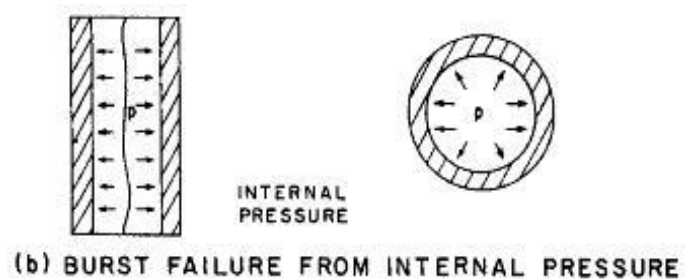
Εικόνα 4.4: Αστοχία της επένδυσης από έκρηξη, λόγω της επίδρασης μεγάλων εσωτερικών πιέσεων (Bourgoyne et al. , 1986).
