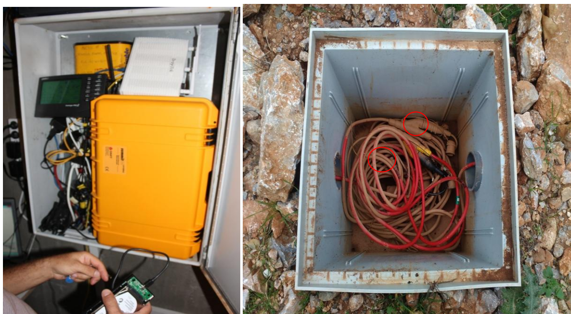
Σχήμα 2.2 : (Αριστερά) Στο εσωτερικό του αντλιοστασίου έχουν τοποθετηθεί ο σειсмоγράφος, υπολογιστής, ο δέκτης δορυφορικού εντοπισμού, η μονάδα καταγραφής του μετεωρολογικού σταθμού, τα συστήματα τηλεπικοινωνιών. (Δεξιά) Γεώφωνα τοποθετημένα μέσα στο φρεάτιο για την προστασία τους.
