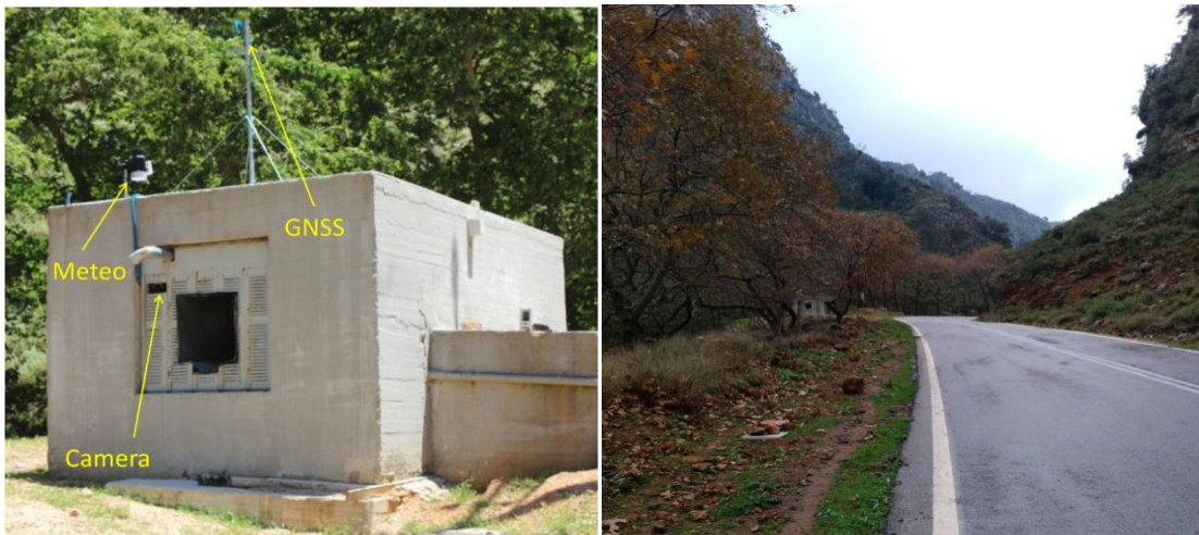
Σχήμα 2.4: (Αριστερά): Εξωτερική άποψη του αντλιοστασίου με επισήμανση των θέσεων εγκατάστασης των επιστημονικών οργάνων ανίχνευσης κίνησης (camera), κεραίας του δορυφορικού συστήματος εντοπισμού (GNSS) και μετεωρολογικός σταθμός (meteo). (Δεξιά) Θέσεις φρεατίων.
