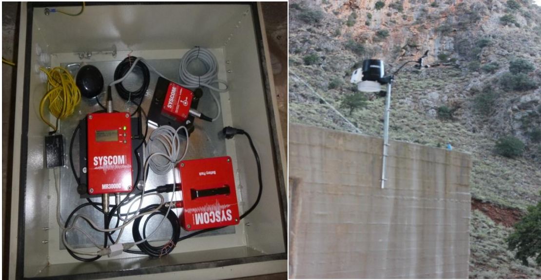
Σχήμα 2.3: (Αριστερά) ο επιταχυνσιογράφος. (Δεξιά) Ο αυτόματος μετεωρολογικός σταθμός στη θέση πιλοτικής εγκατάστασης του συστήματος ανίχνευσης βραχοπτώσεων.
