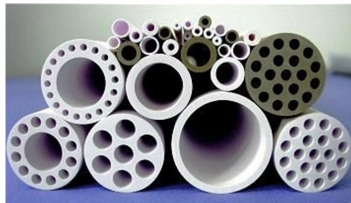
Εικόνα 2.5. Επιμήκεις κεραμικές μεμβράνες κυκλικής διατομής, μονών και πολλαπλών καναλιών [38].
