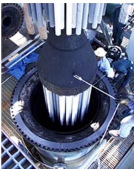
Εικόνα 2.3. Συστοιχία φίλτρων candle filters και ειδικός θάλαμος τοποθέτησης.
