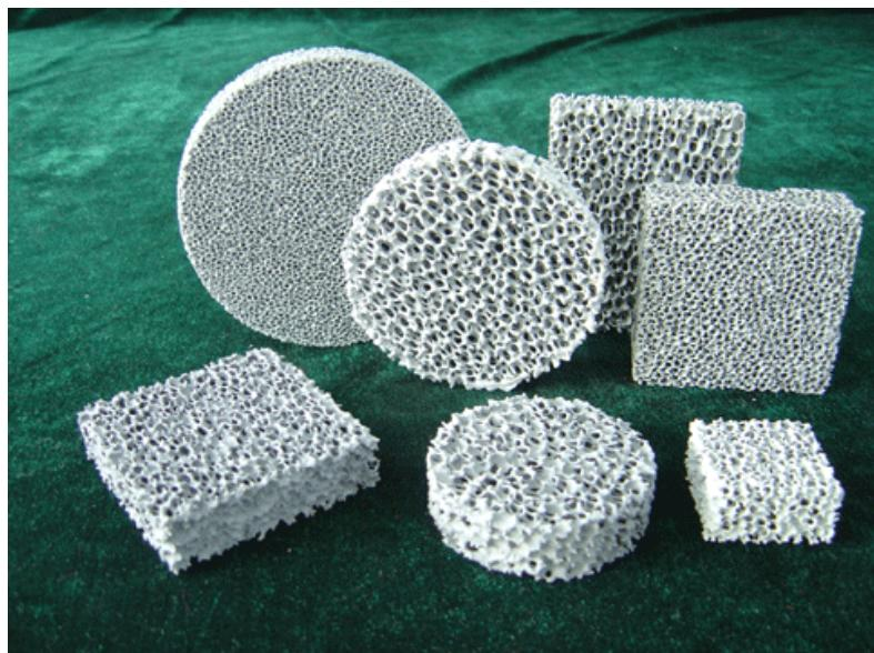
Εικόνα 2.4. Κεραμικοί αφροί με διάφορα μεγέθη πόρων και σε διάφορα σχήματα [41].
