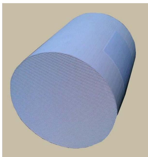
Εικόνα 2.2. Κεραμικό φίλτρο κυψελοειδούς δομής από κορδιερίτη της εταιρίας SentroTech.
