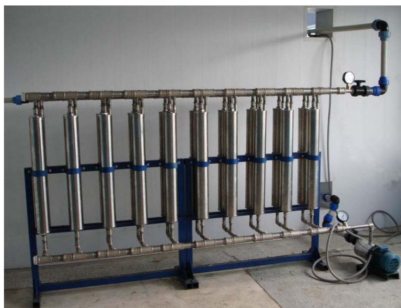
Εικόνα 2.9. Συστοιχία κεραμικών φίλτρων για υπερ-διήθηση (Ultrafiltration) [43].
