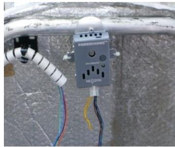
Εικόνα 50: Αισθητήρας υδρογόνου
