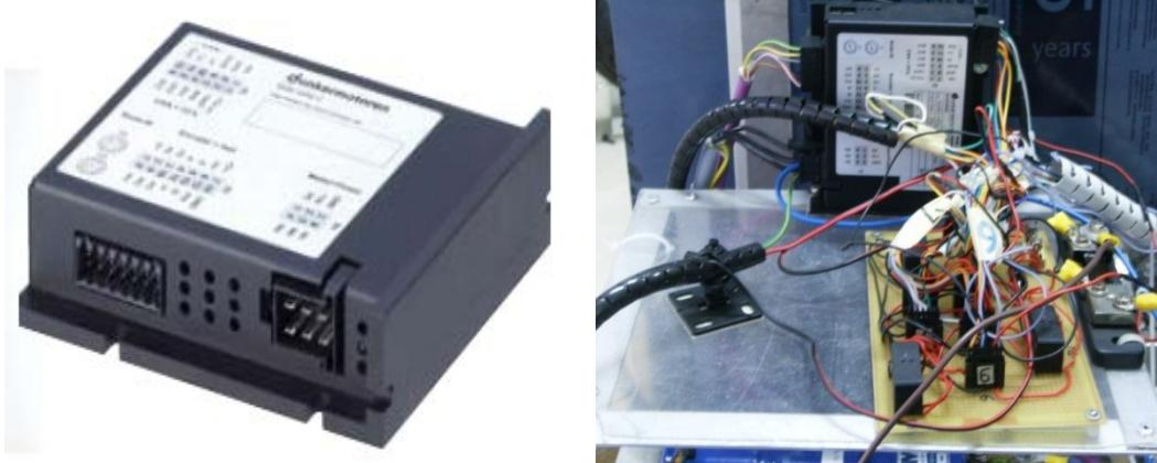
Εικόνα 31: Ο ελεγκτής του ηλεκτροκινητήρα
