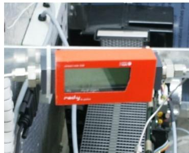
Εικόνα 48: Το ροόμετρο που έχει τοποθετηθεί στο όχημα ER10
