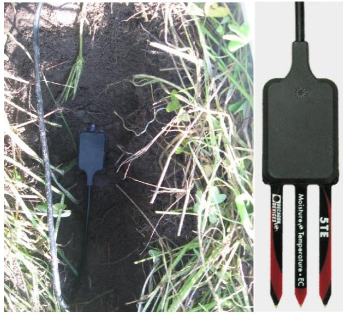
**Εικόνα 6.2: Διαδικασία μέτρησης της εδαφικής υγρασίας & αισθητήρας μέτρησης της υγρασίας, της αγωγιμότητας και της θερμοκρασίας.**
