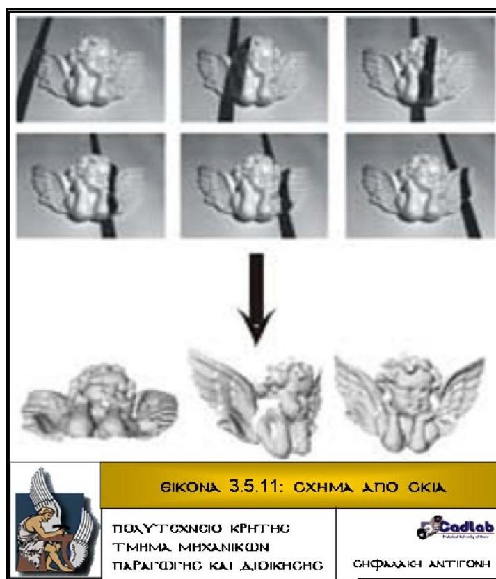
Η μέθοδος Σχήμα-Από-Σκιά ανήκει στην κατηγορία των παθητικών μεθοδολογιών ανακατασκευής τρισδιάστατων επιφανειών. Το τρισδιάστατο μοντέλο δημιουργείται από τη μελέτη της πληροφορίας που περιέχει η διάχυση της σκιάς που δημιουργεί το ίδιο το αντικείμενο, καθώς αυτό φωτίζεται από μια κινούμενη πηγή φωτός. Φανταστείτε για παράδειγμα τις μεταβολές στη σκιά ενός στύλου καθώς ο ήλιος κινείται. Με την παρατήρηση των μεταβολών που δέχεται το σχήμα των σκιών
