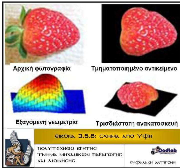
κάθετες υπολογίζονται. Αν υποτεθεί ότι οι κάθετες είναι αρκετά πυκνές και η επιφάνεια είναι ομαλή, τότε ο χάρτης αυτός μπορεί να χρησιμοποιηθεί για την τρισδιάστατη ανακατασκευή του αντικειμένου. Η τεχνική αυτή χρησιμοποιείται κυρίως για την ανακατασκευή επιφανειών από ύφασμα ή για το ανθρώπινο δέρμα.
