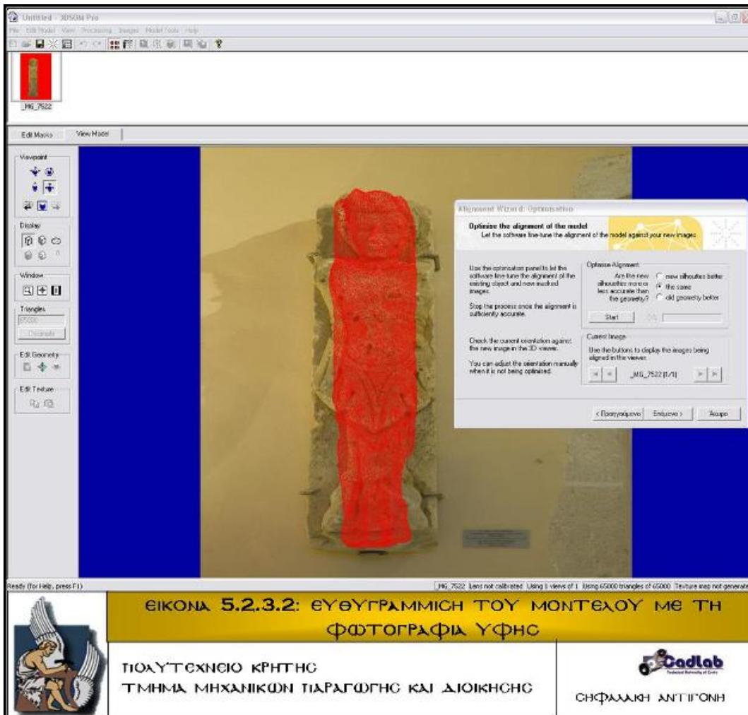
Το τρισδιάστατο αντικείμενο έχει αποκτήσει την τελική του μορφή και εξάγεται σε μορφή *vrml* ώστε να χρησιμοποιηθεί σε εφαρμογές προβολής στο διαδίκτυο. (εικόνα 5.2.3.3)
