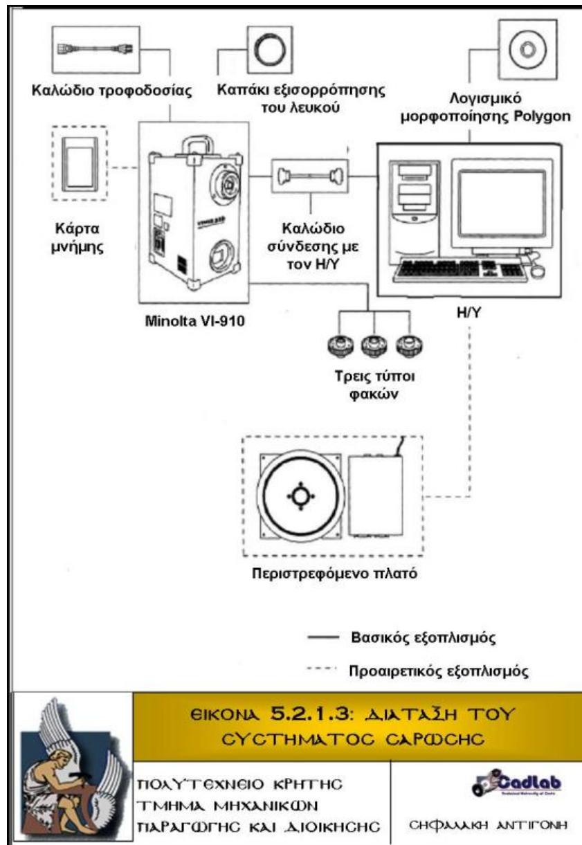
λευκού (white balance cap), τρεις τύποι φακών και το μητρικό λογισμικό της (Polygon Editing Tool) για την επεξεργασία των δεδομένων. Προαιρετικά χρησιμοποιείται μια μνήμη flash για την αποθήκευση των δεδομένων καθώς και ένα περιστρεφόμενο πλατό για την τοποθέτηση του αντικειμένου που θα ψηφιοποιηθεί. Πριν την έναρξη της ψηφιοποίησης, προσαρμόζεται το καπάκι εξισορρόπησης του λευκού στο σαρωτή ώστε να βαθμονομηθεί το λευκό χρώμα. Η ρύθμιση αυτή πραγματοποιείται αυτόματα.
