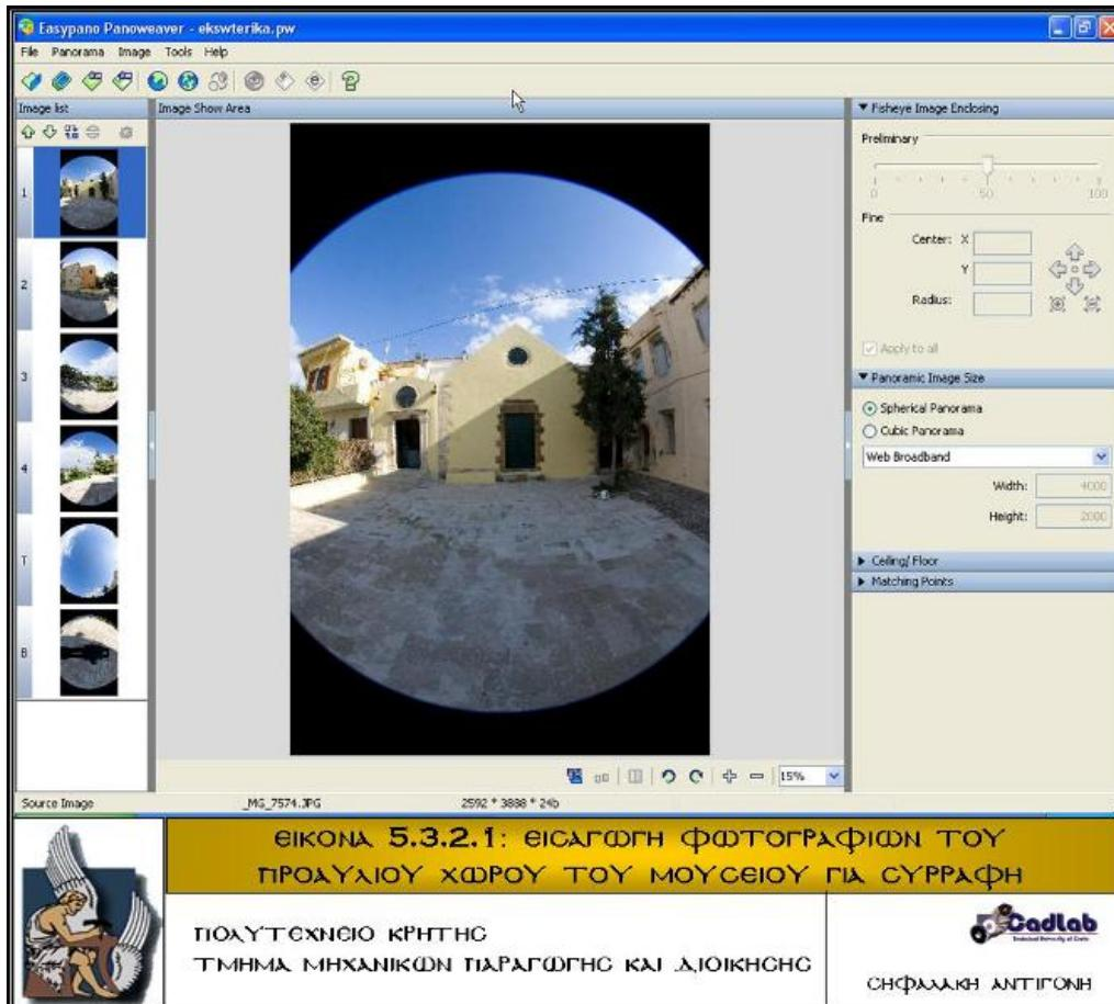
πλήρες πανόραμα από τέσσερις πανοραμικές φωτογραφίες περιφερειακά συν τις φωτογραφίες οροφής και δαπέδου (full frame image 4+T+B). Αφού επιλεγεί η πρώτη και δεδομένου ότι η φωτογράφηση έχει γίνει με τη σωστή σειρά, επιλέγονται αυτόματα οι υπόλοιπες και τοποθετούνται στη λίστα φωτογραφιών.
