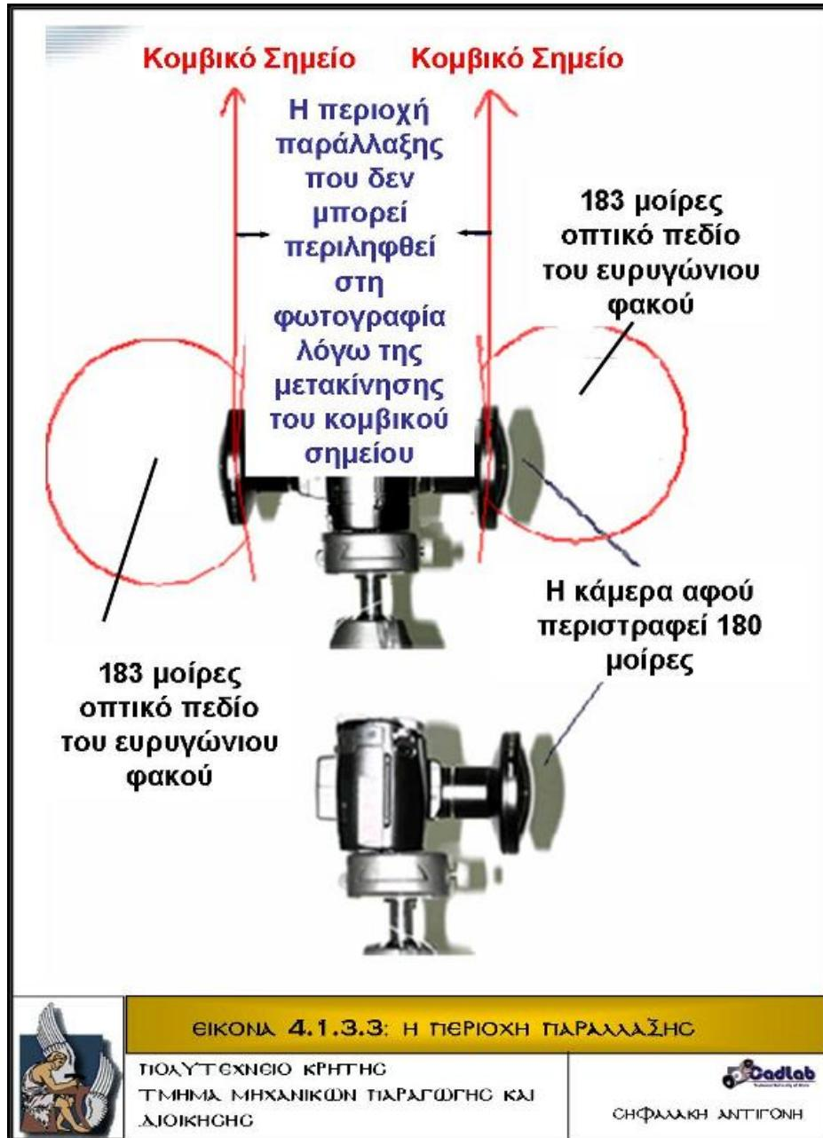
Η χρήση της κεφαλής διασφαλίζει ότι το λογισμικό που θα χρησιμοποιηθεί για τη συρραφή των φωτογραφιών θα παράγει ένα εικονικό περιβάλλον στο οποίο θα χρειαστεί ελάχιστη μεταεπεξεργασία και διόρθωση.
