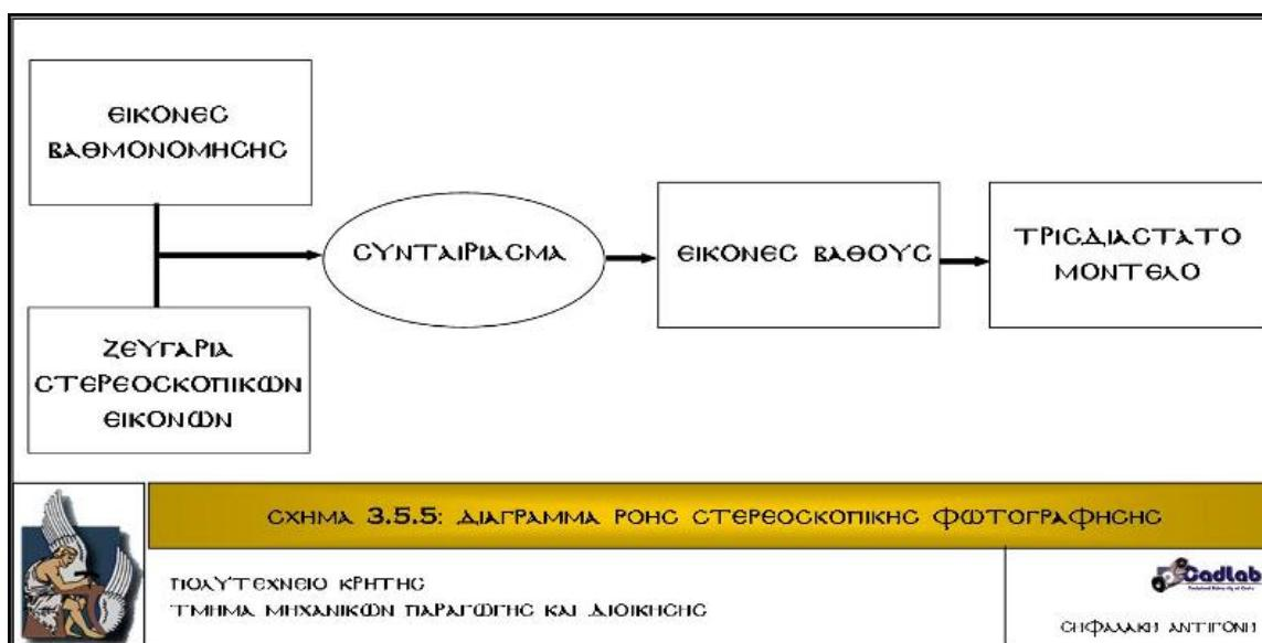
διαγράμματος ροής, που ακολουθείται για την ανακατασκευή γεωμετρίας από στερεοφωτογράφηση φαίνεται στην εικόνα 3.5.5.
