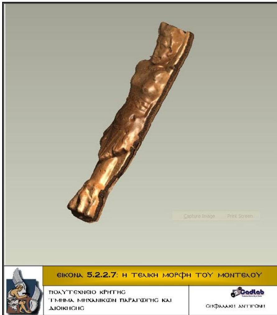
Το μοντέλο αυτό θα υποστεί περαιτέρω επεξεργασία στο 3D SOM, με στόχο να βελτιστοποιηθεί η μορφή του. Το λογισμικό αυτό μπορεί να διαχειριστεί μέχρι 65.000 πολύγωνα, ενώ το μοντέλο την παρούσα στιγμή αποτελείται από 532.784 πολύγωνα. Η μείωση επιτυγχάνεται χρησιμοποιώντας την εντολή *Decimate polygons*. Το τελικό μοντέλο, όπως είναι ευνόητο, θα υστερεί σε λεπτομέρεια συγκριτικά με το αρχικό, αλλά αυτό δεν έχει σημασία στη συγκεκριμένη περίπτωση, καθώς η υφή θα τελειοποιηθεί στο 3D SOM.
