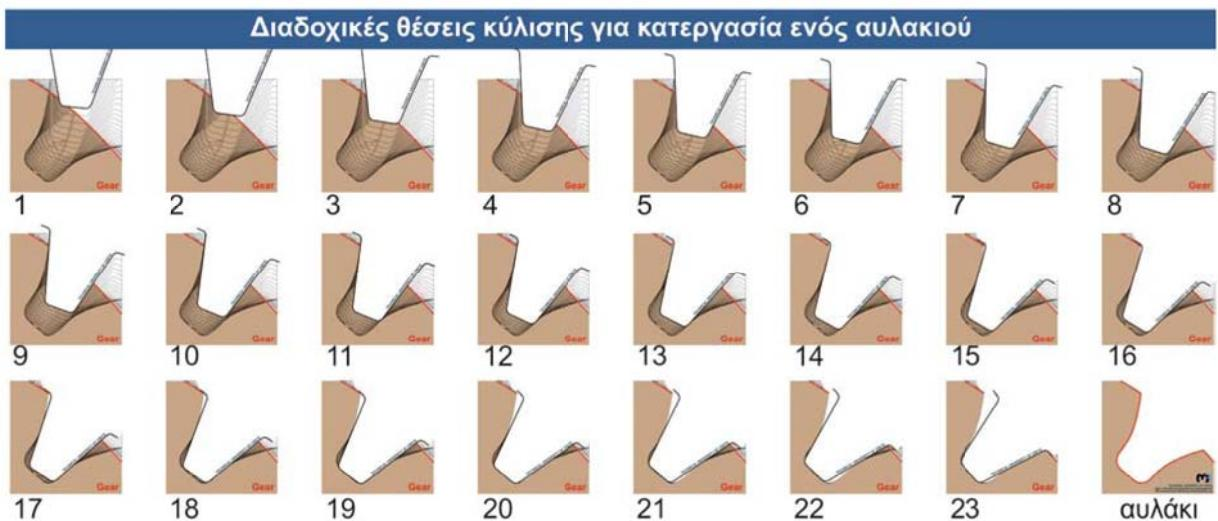
Σχήμα 2.8 Θέσεις κύλισης στο φραιζάρισμα με κύλιση οδοντώσεων
