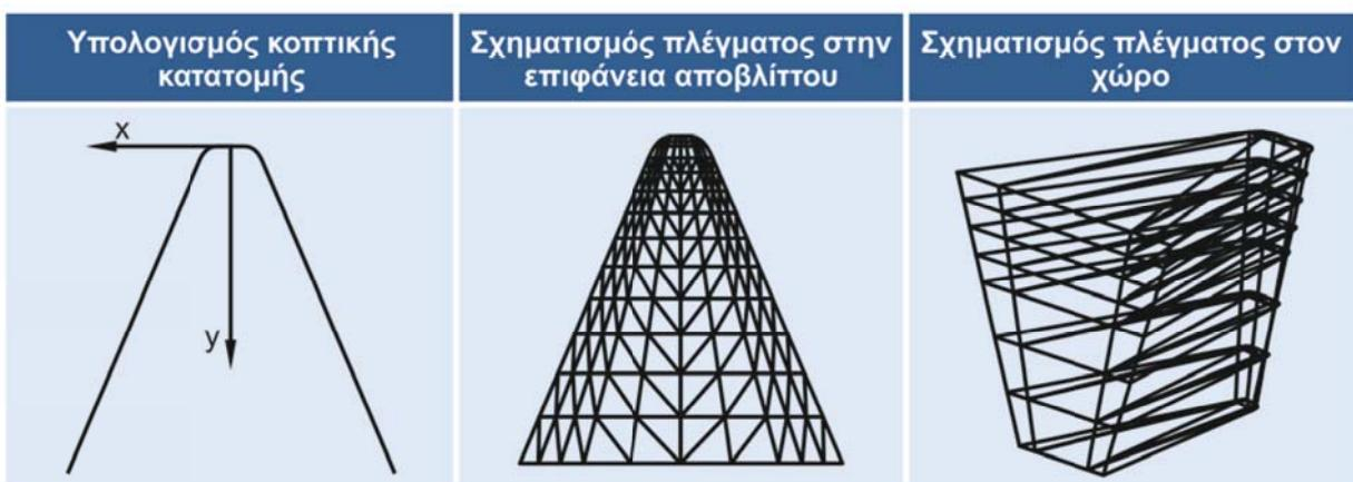
Σχήμα 2.25 Μοντελοποίηση του κοπτικού δοντιού με τη χρήση πεπερασμένων στοιχείων
