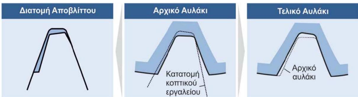
Σχήμα 2.12 Διαδικασία υπολογισμού των διεισδύσεων του κοπτικού εργαλείου με το λογισμικό FRS
