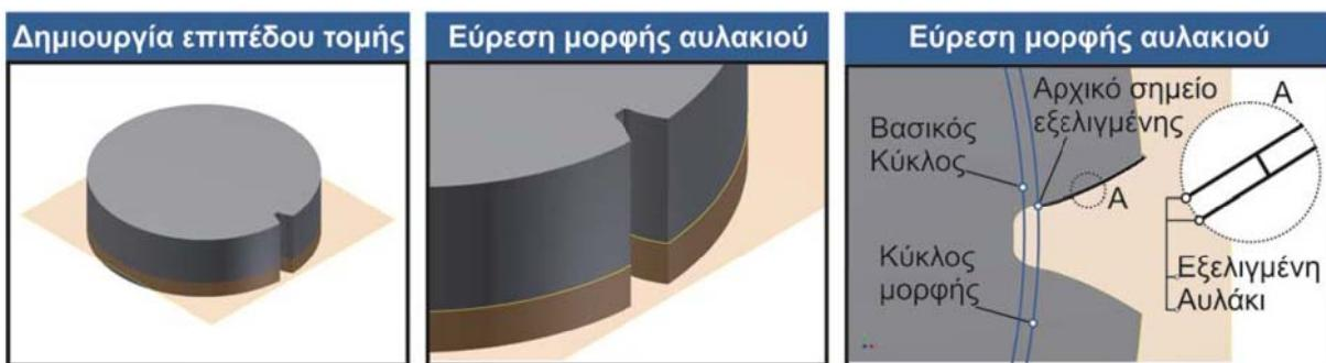
Σχήμα 3.30 Διαδικασία μέτρησης της διαφοράς μεταξύ της υπολογισμένης και της θεωρητικής εξελιγμένης
