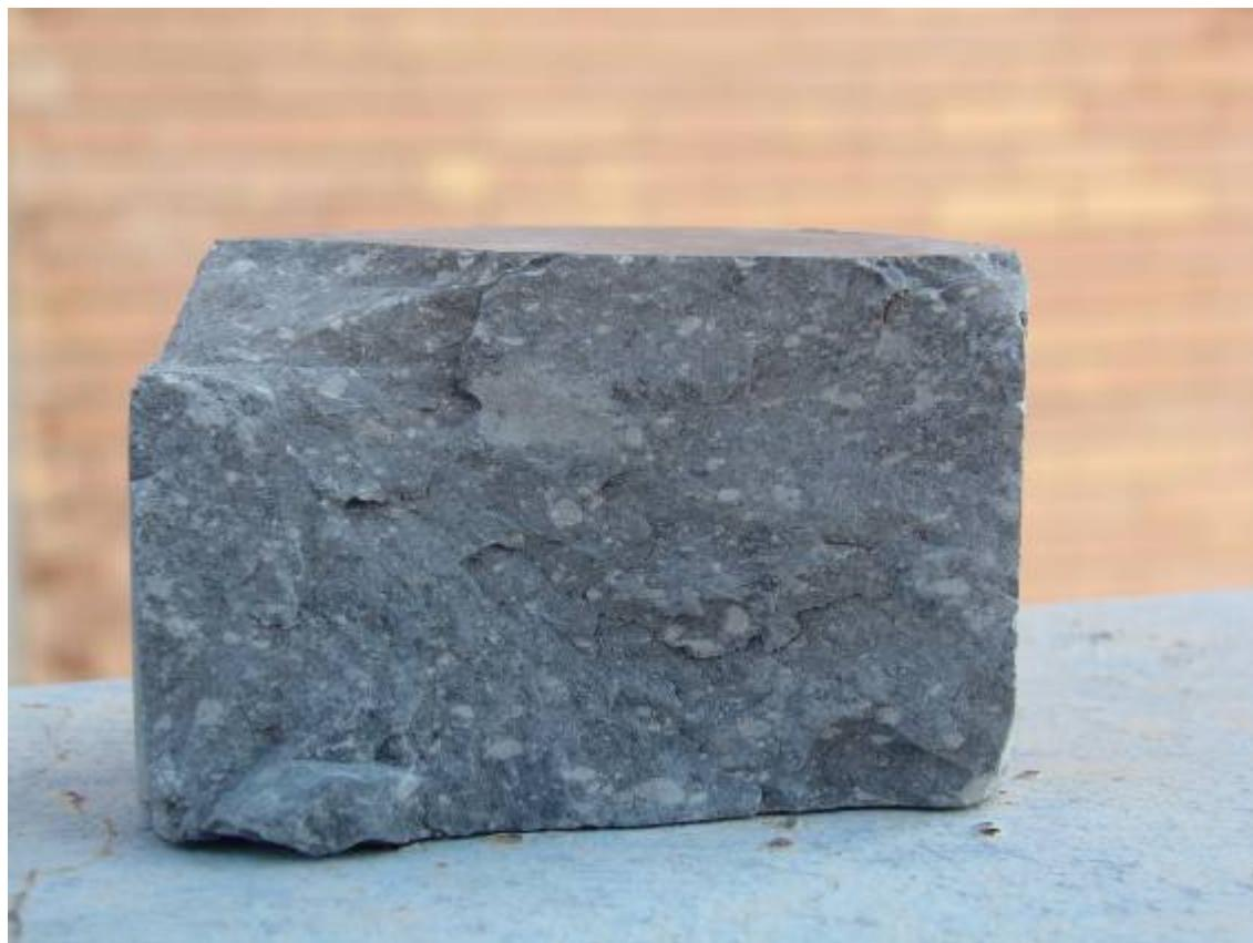
Σχήμα 3.2: Επιφάνεια θραύσης δοκιμίου με ευδιάκριτα συσσωματώματα παιπάλης.
