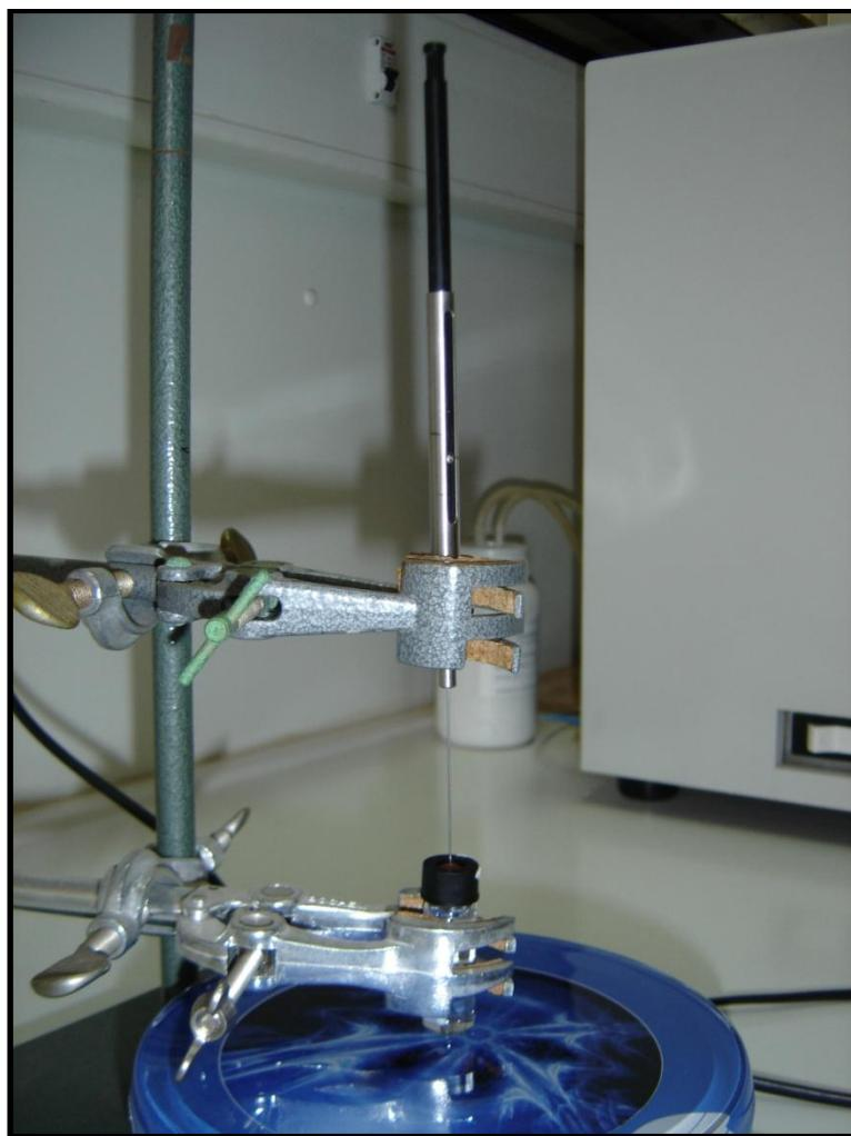
**Εικόνα 4.1:** Πειραματική διάταξη για την εκτέλεση της SPME-HPLC
