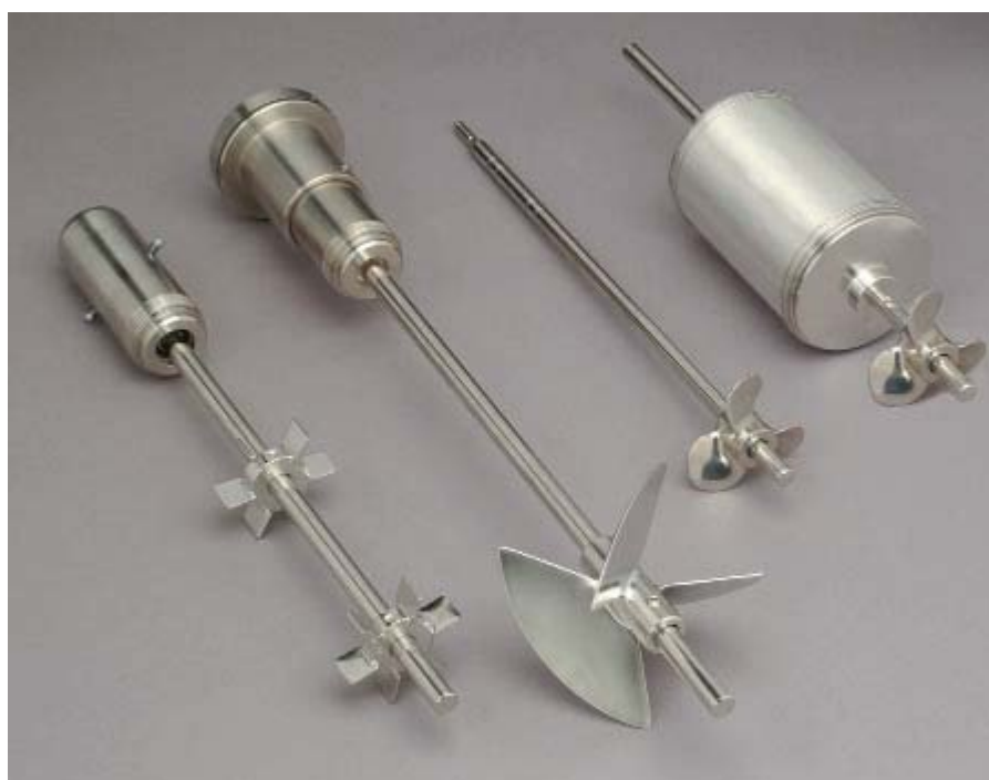
Εικόνα 4.2- Ο κινητήρας ανάδευσης που χρησιμοποιήθηκε είναι ο πρώτος από αριστερά.
