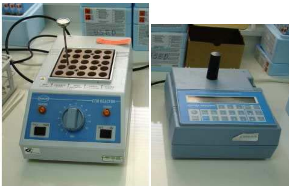
Εικόνα 4.5- COD Reactor της εταιρίας HACH, Model 45600 (α), Portable Data logging spectrophotometer της εταιρίας HACH, DR/2010 (β).
