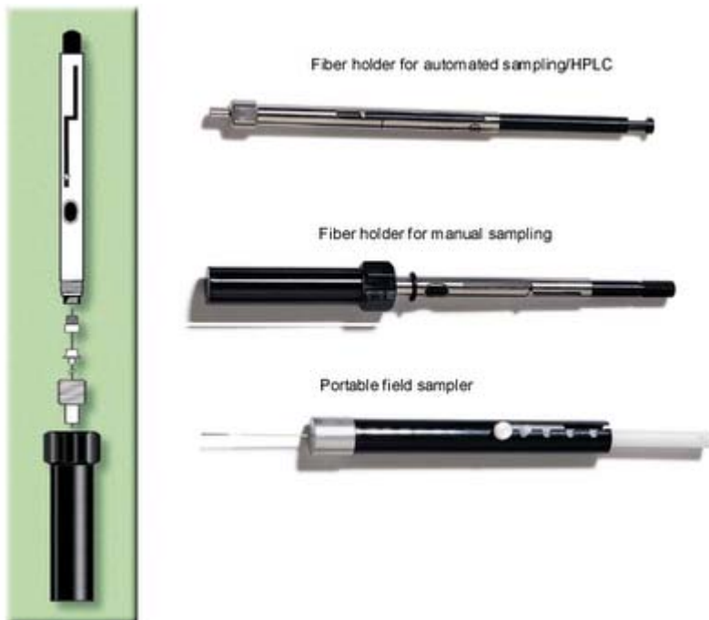
Εικόνα 3: Σχηματική διάταξη της συσκευής SPME [10]
