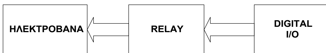
Σχήμα 3-15 Σχηματικό διάγραμμα ηλεκτροβάνας και κυκλώματος οδήγησης
