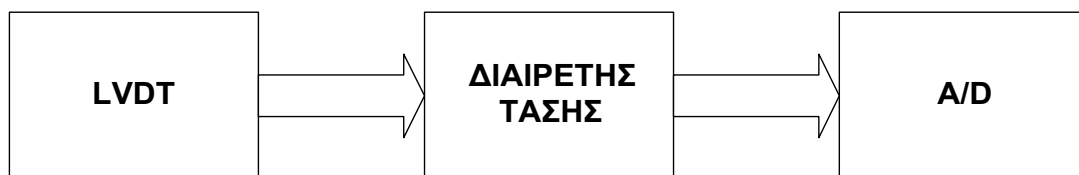
Σχήμα 3-14 Σχηματικό διάγραμμα για το LVDT τύπου Β
