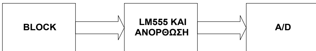
Σχήμα 3-11 Σχηματικό διάγραμμα του Block αισθητήρα και κυκλώματος οδήγησης
