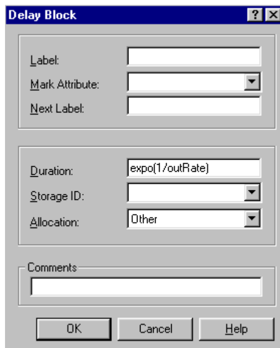
Εικόνα 3.2.5 Το Delay block για την μοντελοποίηση του χρόνου εξυπηρέτησης
