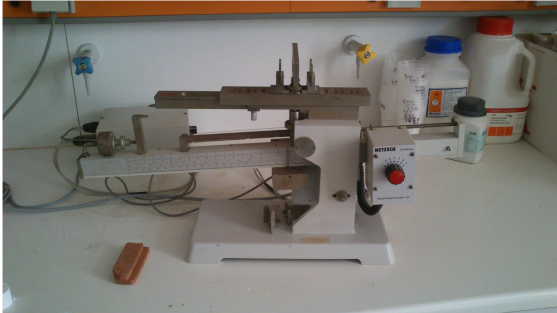
Εικόνα 2.3: Σύστημα δοκιμών κάμψης τριών σημείων (Εργαστήριο Γενικής & Τεχνικής Ορυκτολογίας).
