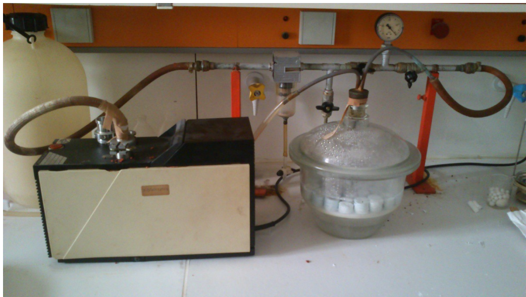
Εικόνα 2.1: Πειραματική διάταξη της μεθόδου DIN EN 993-1 (Εργαστήριο Γενικής & Τεχνικής Ορυκτολογίας).
