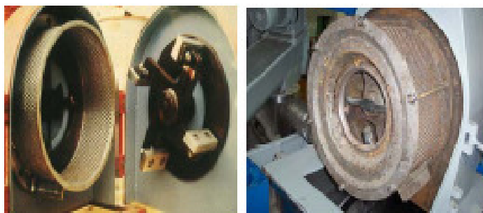
Σχήμα 1.6 : Εσωτερική διάταξη επικρουστικών μύλων
