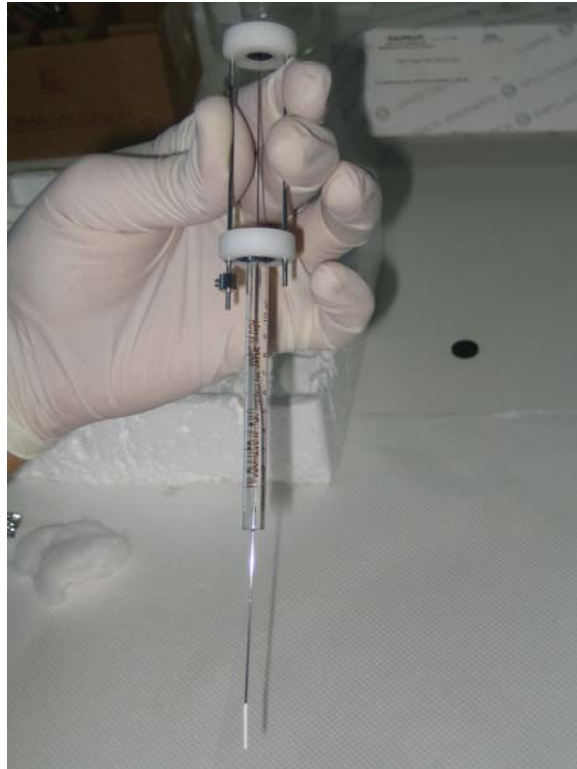
Εικόνα 2. Διάταξη της μικροσύριγγας με την ίνα
