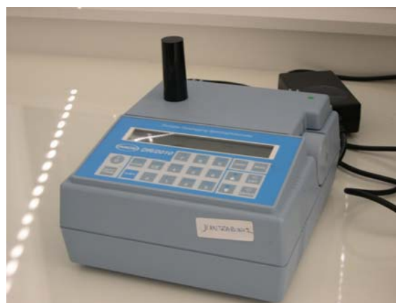
Εικόνα 3.2.1: (α) Αντιδραστήρας C.O.D. και (β) Φασματοφωτόμετρο, για τη μέτρηση του C.O.D.
