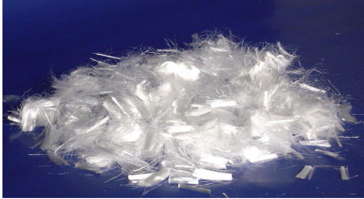
Σχήμα 3.2: Ίνες πολυπροπυλενίου μήκους 6-8mm.
