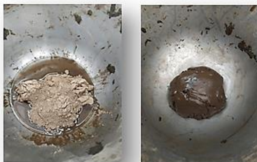
Σχήμα 2.7: Αριστερά το διάλυμα ενεργοποίησης NaOH & \text{Na}_2\text{SiO}_3 με το λειοτριβημένο τούβλο. Δεξιά ο πολφός του ανόργανου πολυμερούς μετά την ανάδευση.
