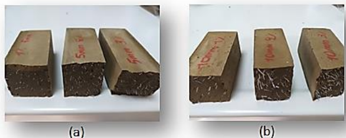
Σχήμα 2.10: (a) Ανόργανα πολυμερή από σκωρία και τούβλο ενισχυμένα με ίνες PET μήκους 4- 6 mm, (b) ανόργανα πολυμερή από τούβλο και σκωρία ενισχυμένα με ίνες PET μήκους 8- 10 mm.
