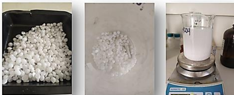
Σχήμα 2.6: Αριστερά φαίνονται τα άνυδρα Pellet NaOH. Δεξιά η διαλυτοποίησή τους σε απιονισμένο νερό με 24ωρη ανάδευση.
