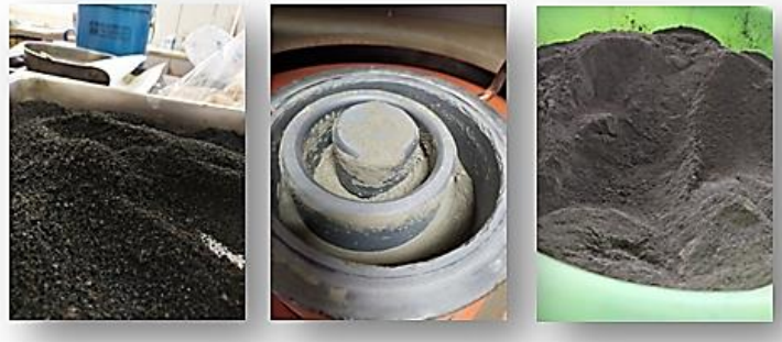
Σχήμα 2.3: Μείωση των κόκκων της σκωρίας με λειοτρίβηση στον δακτυλιόμυλο. Αριστερά το αρχικό υλικό και δεξιά το αποτέλεσμα της επεξεργασίας.
