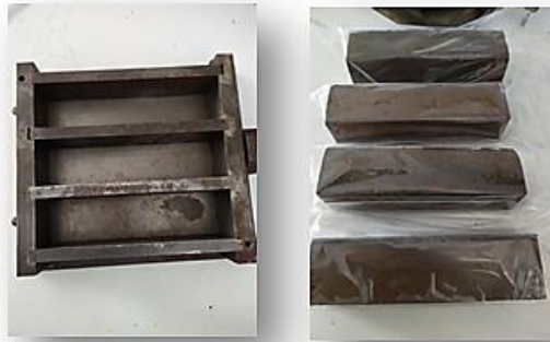
Σχήμα 2.9: Αριστερά οι πρισματικές μήτρες 4x 4x 16 cm 3 , δεξιά τα πρισματικά δοκίμια που κατασκευάστηκαν σε αναλογία τούβλο προς σκωρία 1: 1, με συγκέντρωση διαλύματος NaOH 8 M και θερμοκρασία έψησης 80 °C.
