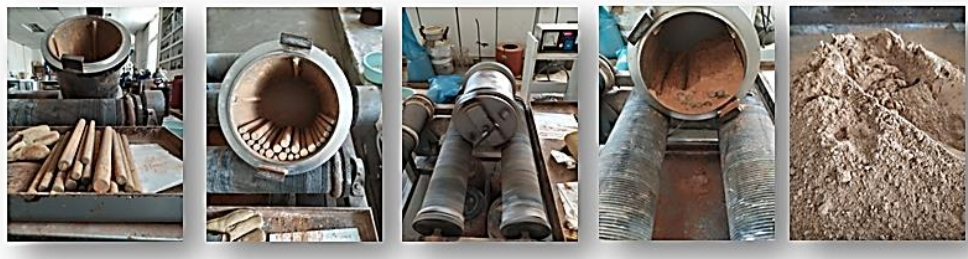
Σχήμα 2.2: Λειοτρίβηση του τούβλου στον ραβδόμυλο. Αριστερά η τοποθέτηση των ράβδων στον μύλο και δεξιά το τελικό προϊόν.
