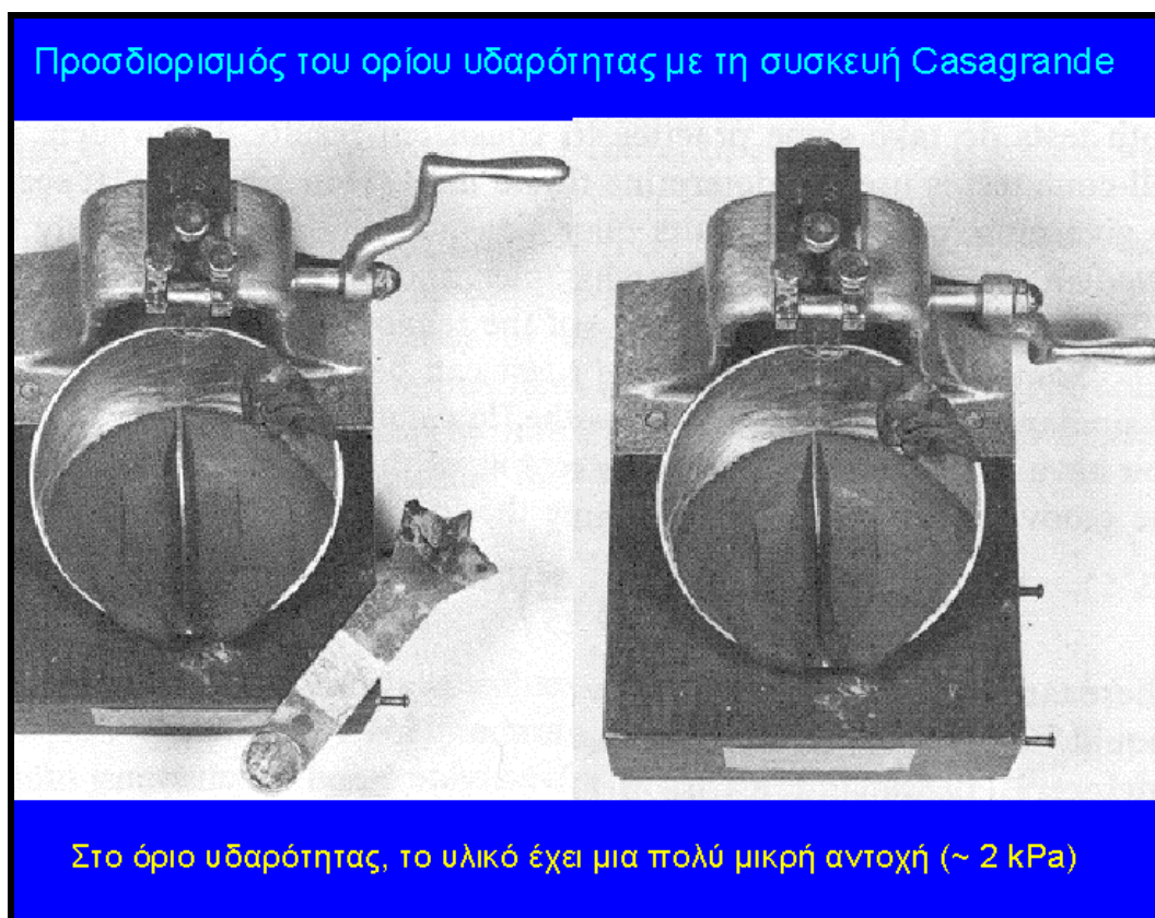
Σχήμα 3.9: Συσκευή Casagrande (Καββαδάς, 2004)
