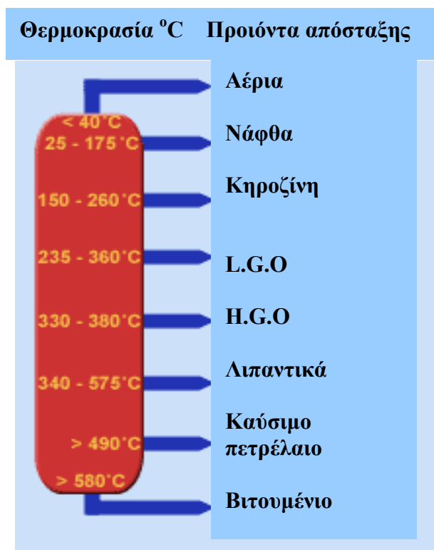
Εικόνα 2.4: Κλασματική στήλη και προϊόντα [Πηγή: http://www.moorlandschool.co.uk/earth/oilrefinery.htm ]
