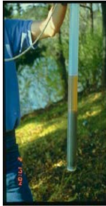
Εικόνα 1.5 : Δειγματολήπτης τύπου bailer με ελεύθερη φάση πάνω στο νερό
