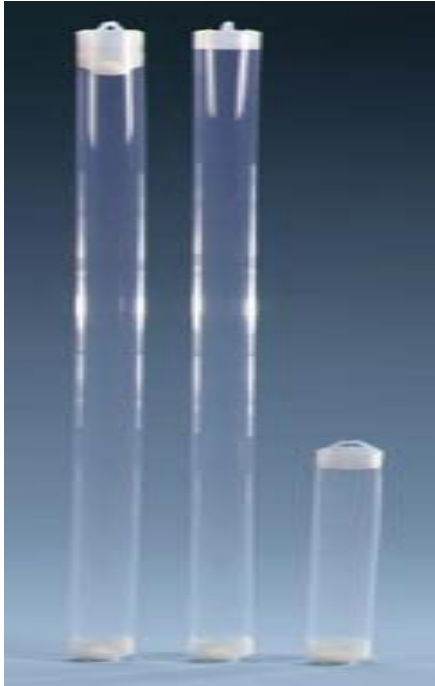
Εικόνα 1.4 : Δειγματολήπτης τύπου bailer με νερό
