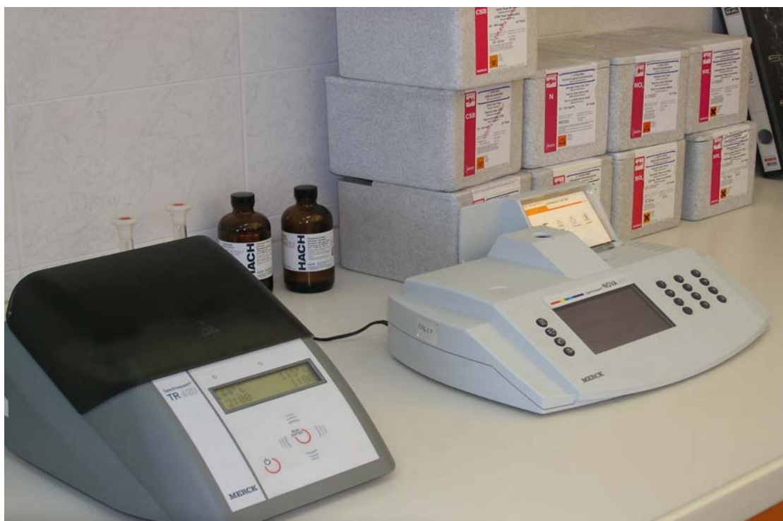
Εικόνα 8. Όργανα μέτρησης συγκεντρώσεων ( [\text{NH}_4^+-\text{N}] , [\text{NO}_3^--\text{N}] , TKN, COD).
