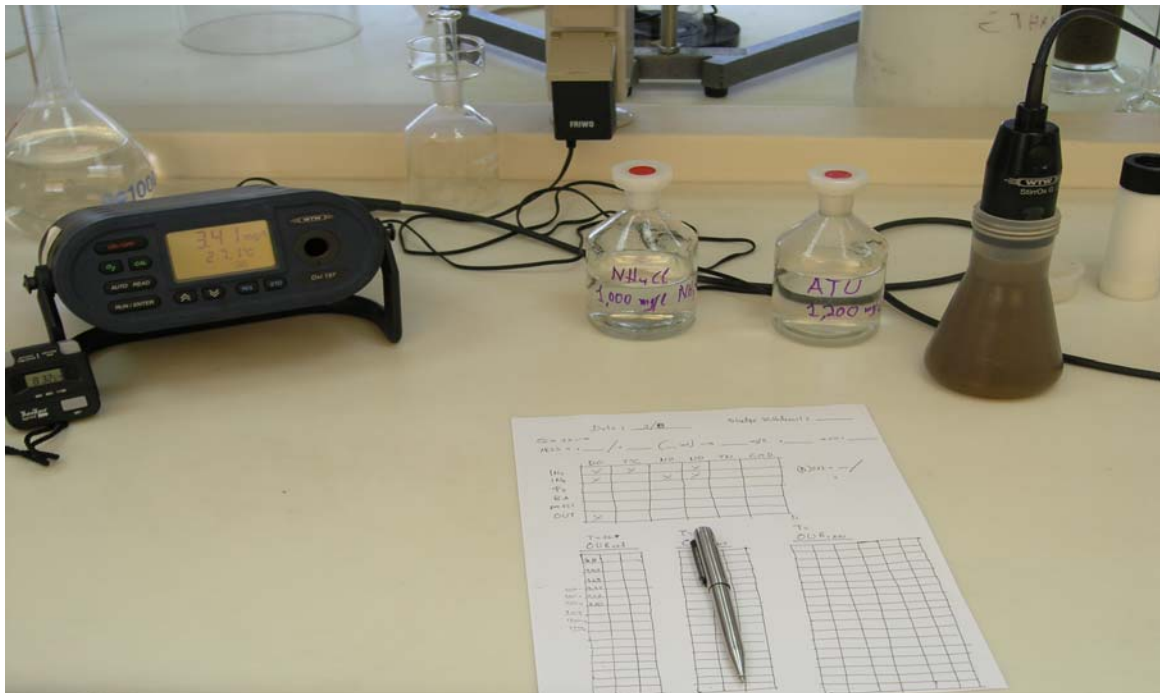
Εικόνα 10. Διάταξη υπολογισμού O.U.R.
