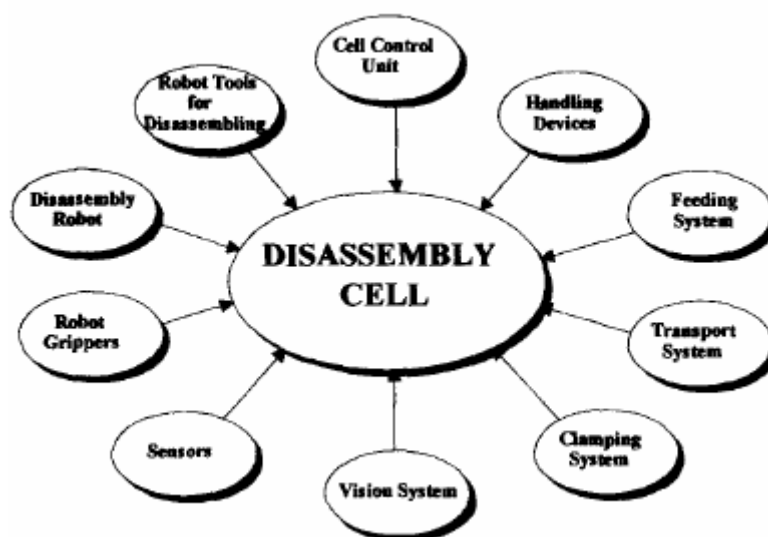
Σχήμα 5.5. Τμήματα ενός κελιού αποσυναρμολόγησης
