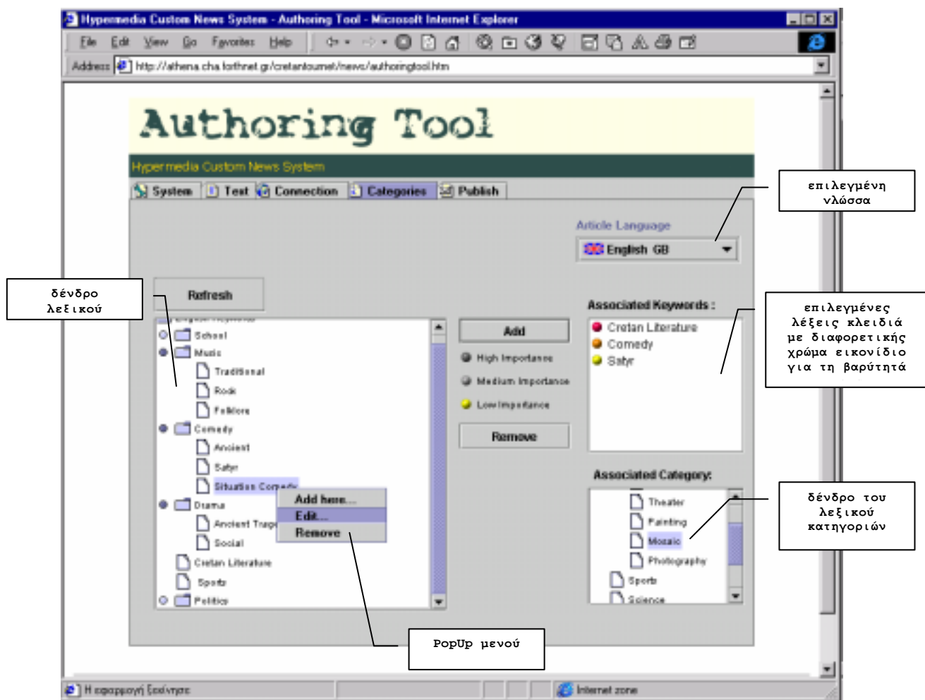
Εικόνα 6-4 Το συστατικό κατηγοριοποίησης εγγράφων και διαχείρισης λεξικών, όπως έχει ενσωματωθεί στο υποσύστημα συγγραφής εγγράφων
