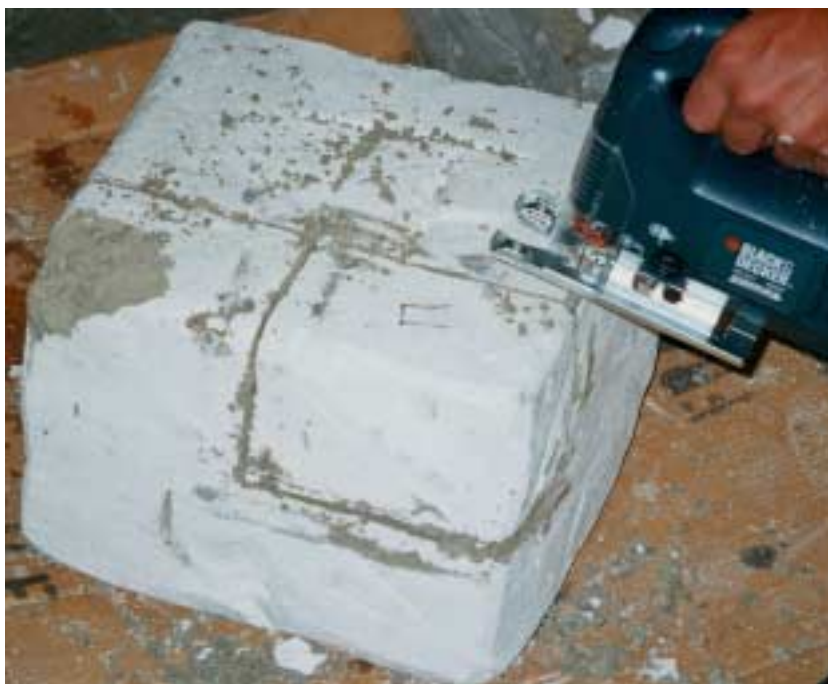
Εικόνα 3.1: Κοπή τμήματος του αδιατάρακτου τεμάχους για τη διαμόρφωση δοκιμίου.
