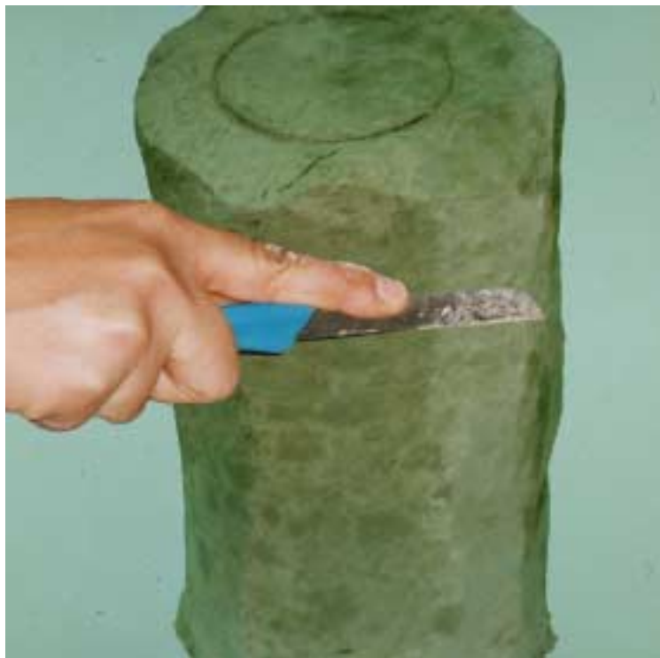
Εικόνα 3.2: Διαμόρφωση δοκιμίου για τη δοκιμή ανεμπόδιστης θλίψης.
