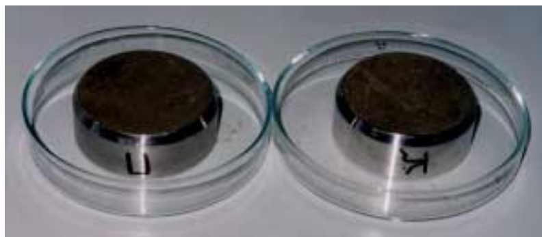
Εικόνα 3.4: Προσανατολισμένα δοκίμια για τη δοκιμή στερεοποίησης.
