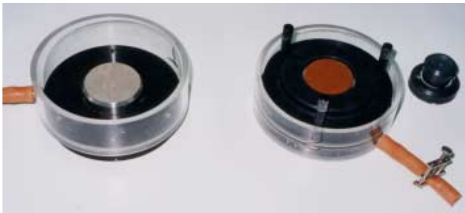
Εικόνα 5.2: Κελιά φόρτισης της συσκευής στερεοποίησης.
