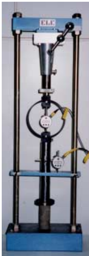
Εικόνα 4.2: Συσκευή φόρτισης με εδαφικό δοκίμιο πριν την έναρξη της δοκιμής.
