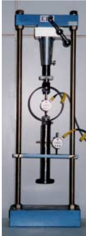
Εικόνα 4.1: Εργαστηριακή συσκευή δοκιμής ανεμπόδιστης θλίψης.
