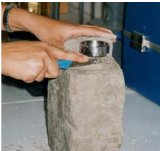
Εικόνα 3.3: Διαμόρφωση δοκιμίου για τη δοκιμή της στερεοποίησης.
