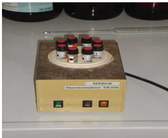
Σχήμα 3-1 Θερμοαντιδραστήρας χώνευσης.
