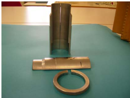
Σχ. 4.3. Ο μορφοποιητής δοκιμίου και ο μεταλλικός δακτύλιος που τον συγκρατεί.
