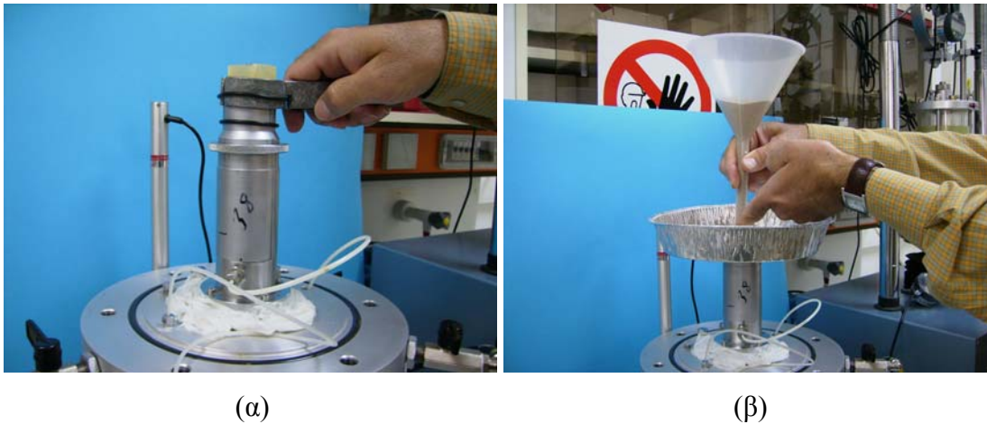
Σχ. 4.6: (α) δύο ελαστικοί δακτύλιοι τοποθετούνται με τη χρήση του εξολκέα στην κορυφή του μορφοποιητή, (β) το ειδικό ταψί έχει περαστεί στο μορφοποιητή και με χοάνη αφήνεται να ρεύσει η άμμος στο καλούπι.
