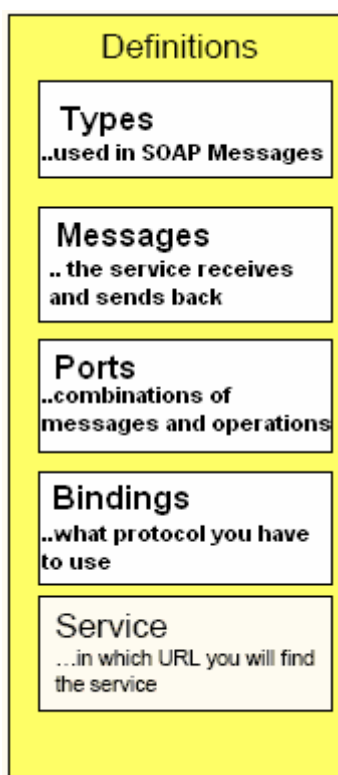
Εικόνα 10: Η δομή του WSDL
