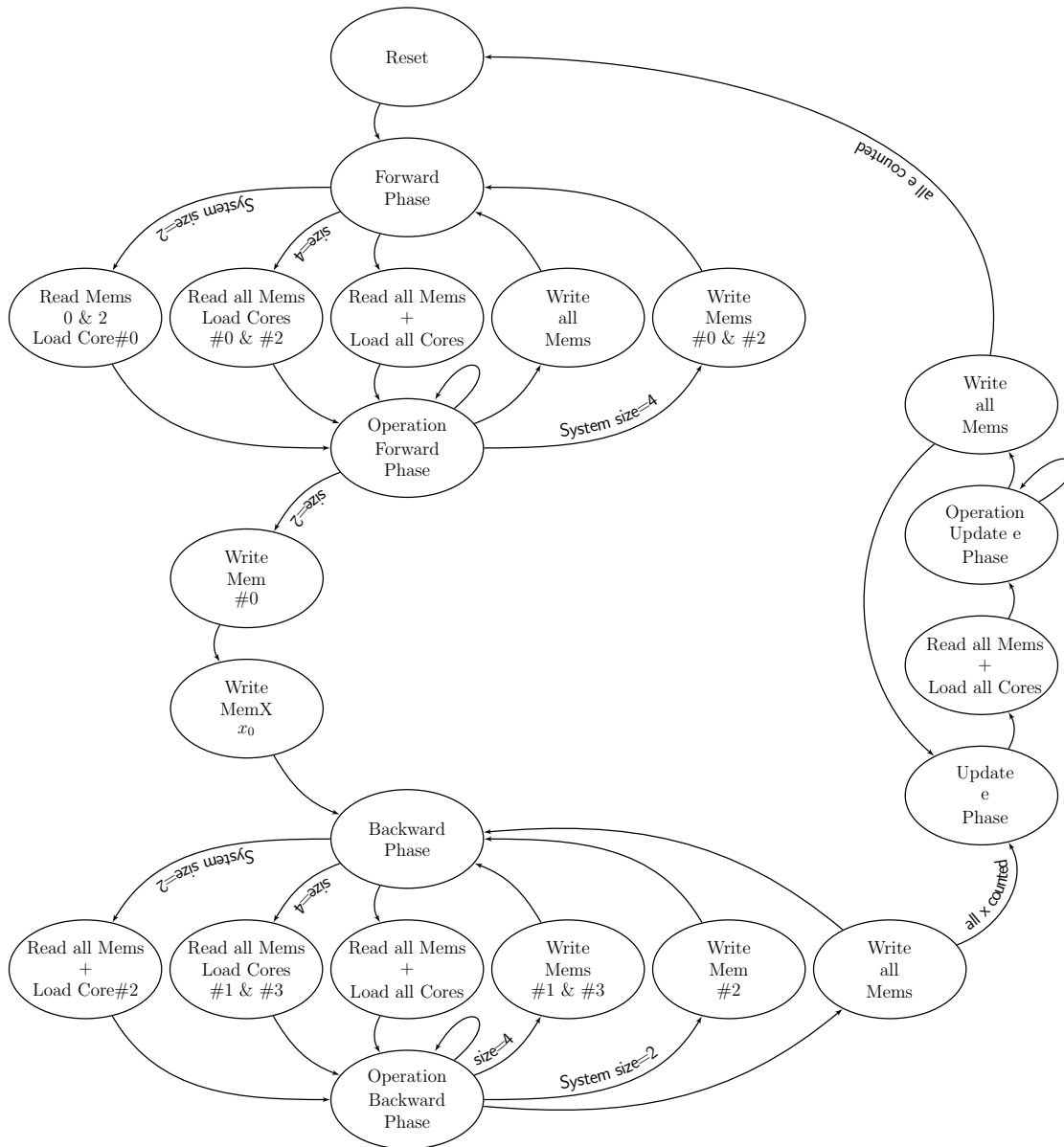
Σχήμα 5.31: Εξωτερική FSM για αρχιτεκτονική με 4 cores
