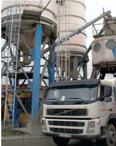
Σχήμα 15: Φόρτωση σκυροδέματος σε αναδευτήρα.
