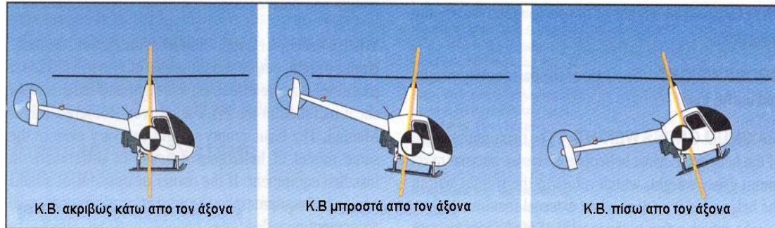
Εικόνα 5.17. Η επίδραση της θέσης του κέντρου βάρους στον χειρισμό του οχήματος.
