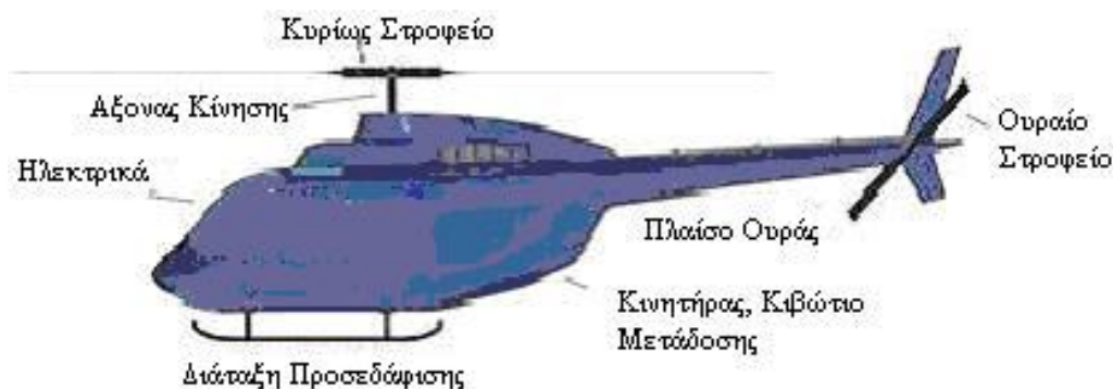
Εικόνα 3.1. Τα τμήματα τυπικής σχεδίασης ελικοπτέρου.
