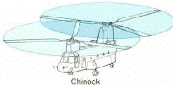
Εικόνα 3.9. Διάταξη δίδυμων στροφείων
