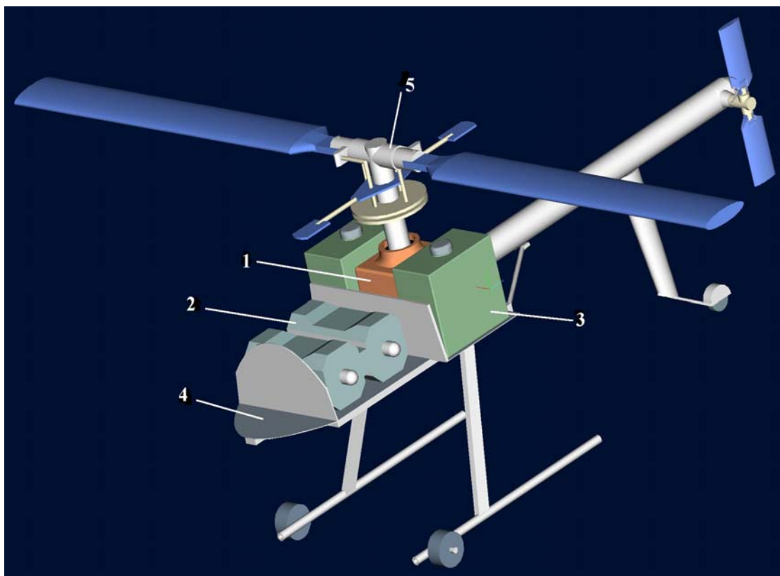
Εικόνα 5.2. Τοποθέτηση των μηχανικών μερών πάνω στο πλαίσιο.
