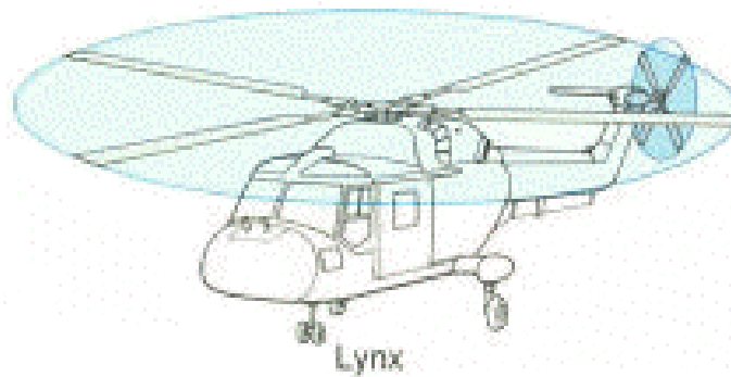
Εικόνα 3.8. Διάταξη κυρίως στροφείου σε συνδυασμό με ουραίο στροφέιο.
