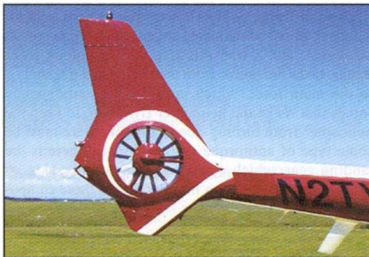
Εικόνα 3.5. Η διάταξη Fenestron.
