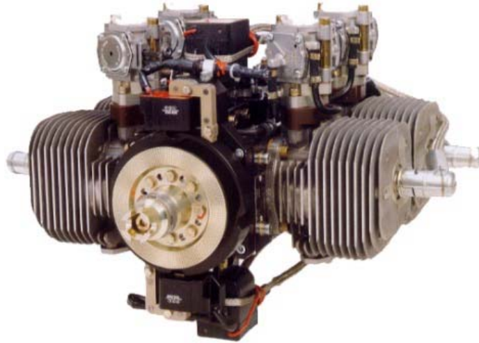
Εικόνα 5.5. Ο κινητήρας Limbach L550 E.
