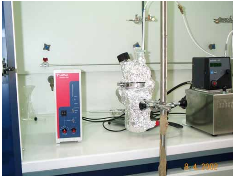
ΕΙΚΟΝΕΣ 9 ΚΑΙ 10: Αντιδραστήρας υπερήχων με ηχόδιο (Ultrason 250, LabPlant Ltd)
