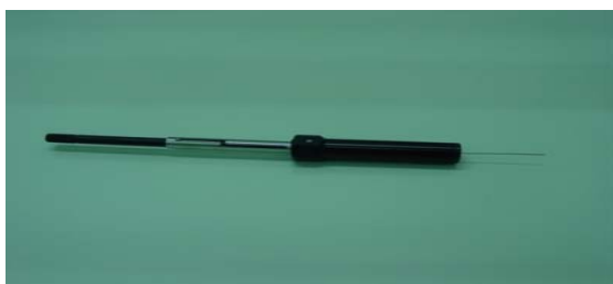
Σχήμα 2.3: Συσκευή συγκράτησης (holder) της ίνας.
