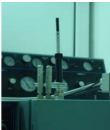
Σχήμα 2.7: Τοποθέτηση της ίνας στον εισαγωγέα του αέριου χρωματογράφου
