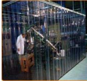
Σχήμα 1.8: Αντιδραστήρας ταχείας πυρόλυσης που μετατρέπει άμεσα τα υπολείμματα ξύλου σε σύνθετο βιοέλαιο [D]
