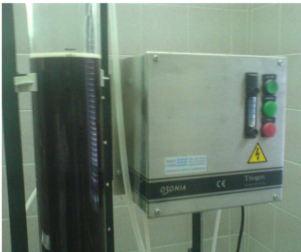
Εικόνα 4.3 Η Γεννήτρια όζοντος δίπλα στην στήλη .
