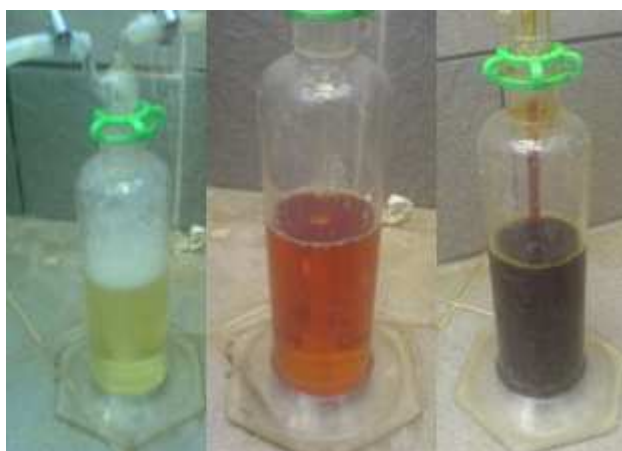
Εικόνα 4.12 «Παγίδες» ιωδίου πριν και μετά την αντίδραση με όζον
