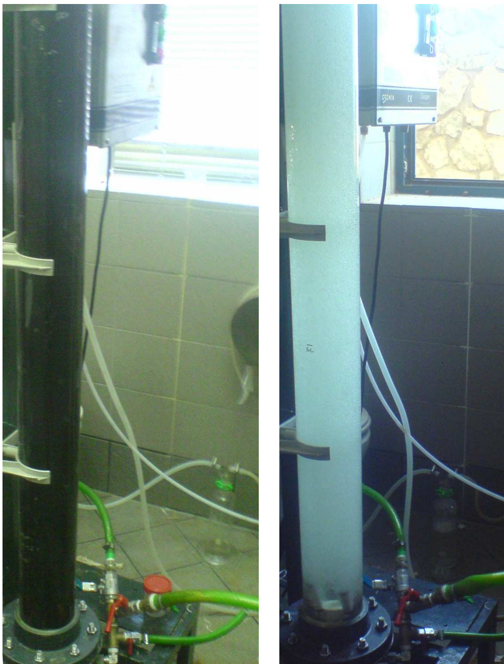
Εικόνα 4.4 .Η στήλη με διασταλλάγματα (αριστερά) και απιονισμένο νερό (δεξιά)
