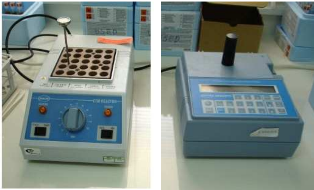
Εικόνα 4.6 COD Reactor της εταιρίας HACH, Model 45600 (α), Portable Data logging spectrophotometer της εταιρίας HACH, DR/2010 (β).
