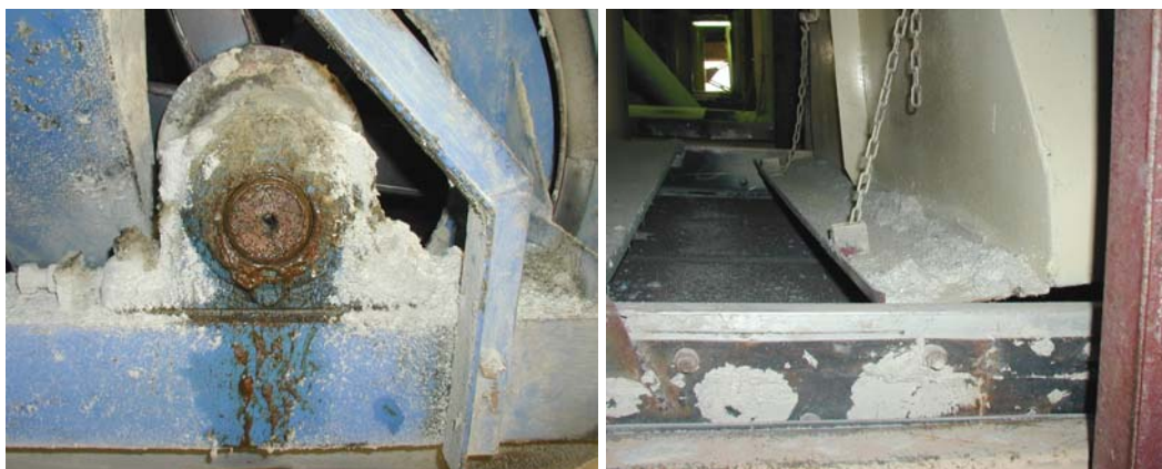
Σχήμα 6.4: Εκτεταμένη ρύπανση του κτιρίου επεξεργασίας από αμιάντο
