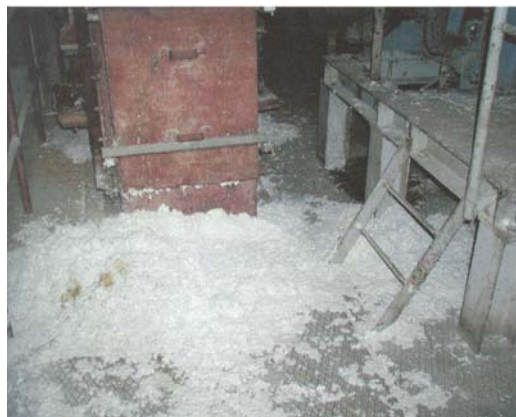
Σχήμα 6.2: Δάπεδο κτιρίου επεξεργασίας γεμάτο ίνες αμιάντου
