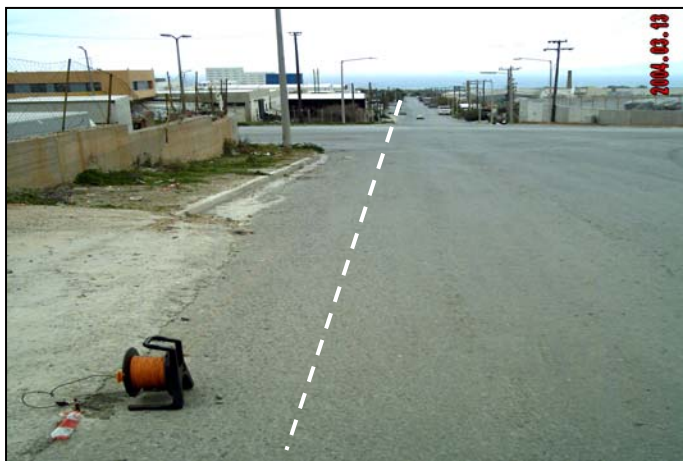
Σχήμα 4.2: Φωτογραφία της περιοχής μελέτης, στην οποία εικονίζεται η δεύτερη γραμμή ηλεκτρικής τομογραφίας T2 (άσπρη διακεκομμένη γραμμή).
