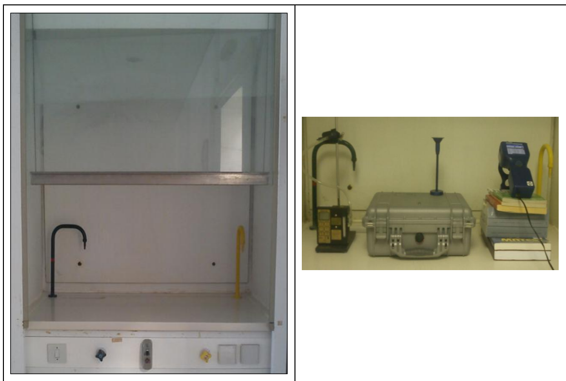
Εικόνα 4.1: Θάλαμος δημιουργίας της ατμόσφαιρας αέρα-σκόνης για τη διεξαγωγή των μετρήσεων και όργανα μέτρησης τοποθετημένα εντός του θαλάμου.
