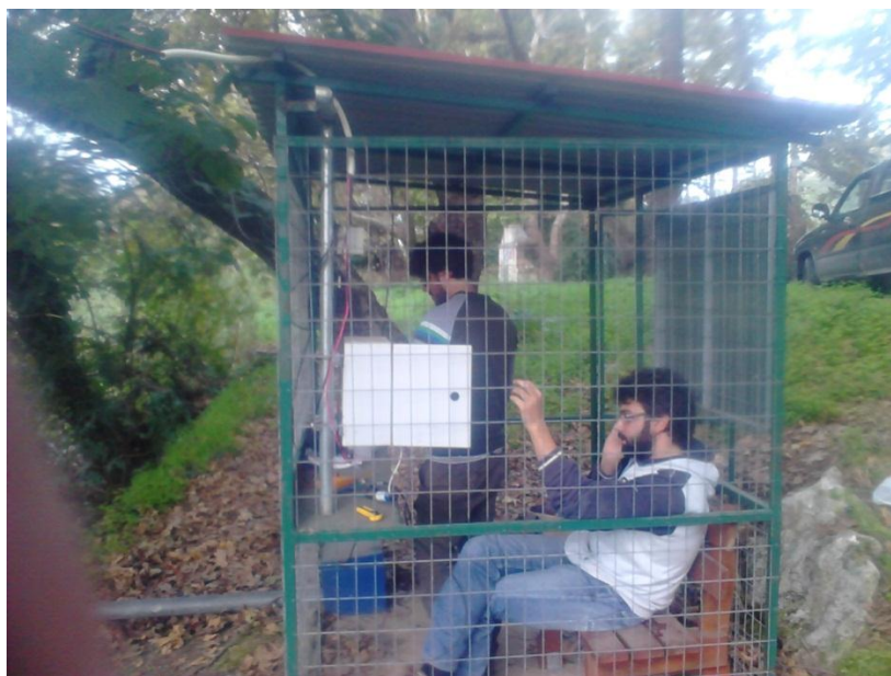
Εικόνα 5.3: Υδρολογικός σταθμός Κερίτη σε διαδικασία συντήρησης και βαθμονόμησης του Troll 9500
