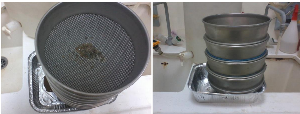
Εικόνα 4-6 Απεικόνιση διάταξης κοσκίνων στη διόρθωση άμμου
