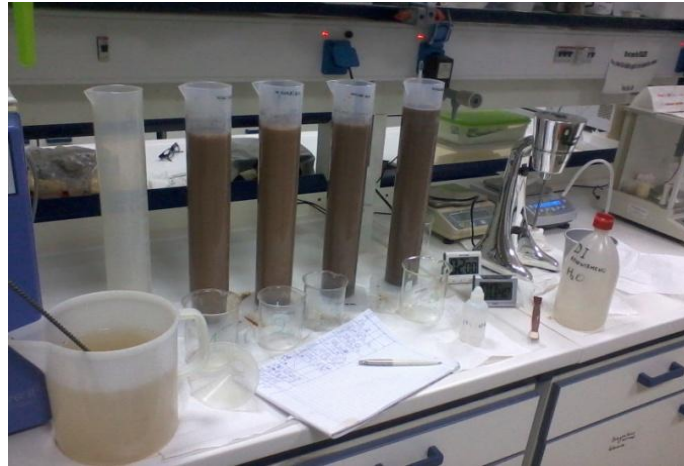
Εικόνα 4-2 πειραματική διάταξη κοκκομετρίας
