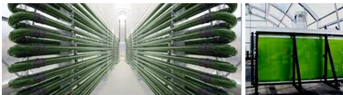
Εικόνα Β.29: Σωληνοειδείς φωτοβιοαντιδραστήρες (αριστερά) και φωτοβιοαντιδραστήρες επίπεδης πλάκας (δεξιά).
