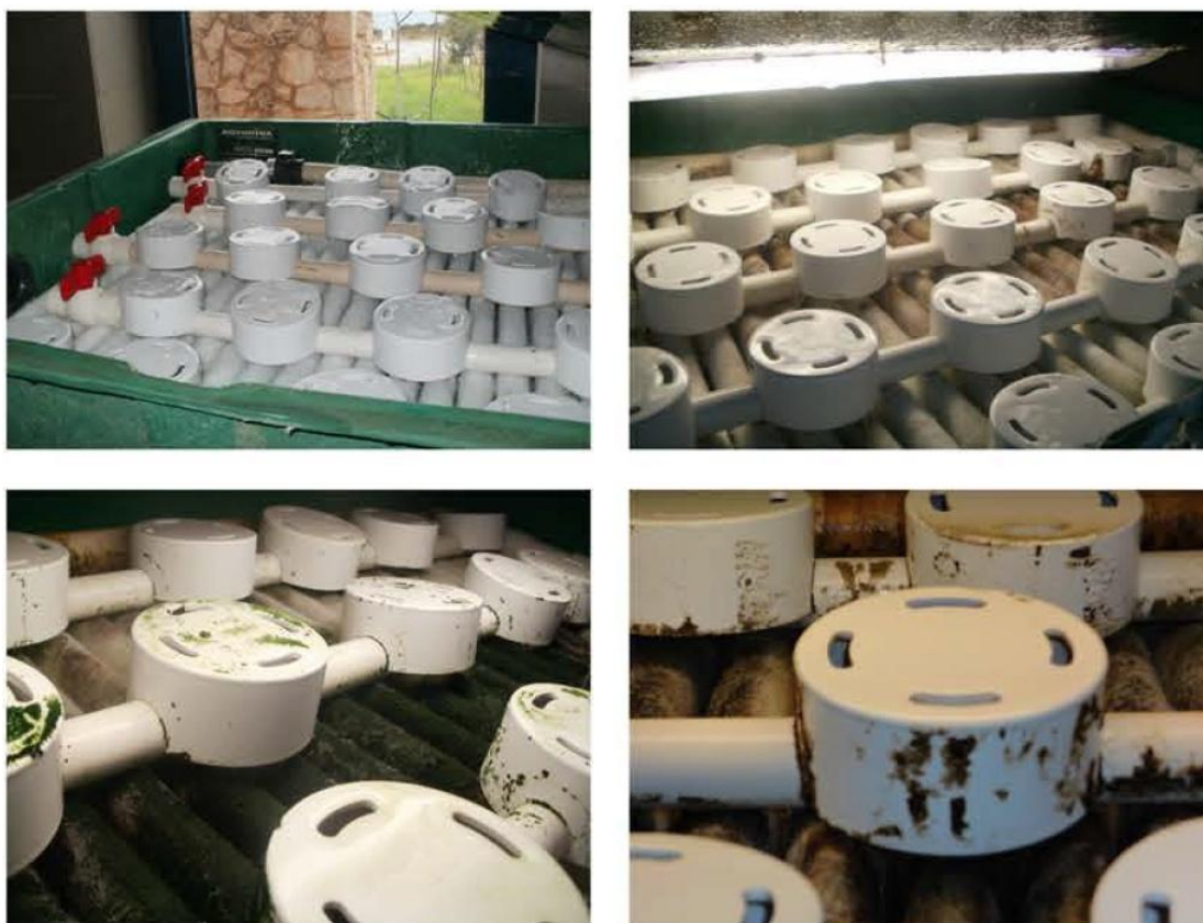
Εικόνα B.33: Χρονική εξέλιξη ανάπτυξης βιοφίλμ: τις πρώτες ημέρες λειτουργίας (επάνω αριστερά), μετά από 2 μήνες (επάνω δεξιά) και μετά από 3 μήνες λειτουργίας (κάτω δεξιά) και μετά τον εμβολιασμό μικροαλγών (κάτω αριστερά).
