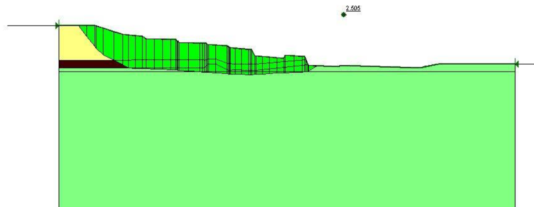
Εικόνα 4.19: Καμπύλη αστοχίας όταν στρώμα άμμου στα 4m βάθος με νερό με Ru=0.4 για όλα τα στρώματα.
