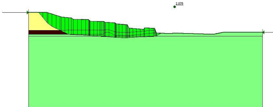
Εικόνα 4.17: Καμπύλη αστοχίας όταν στρώμα άμμου στα 4m βάθος με νερό με Ru=0.3 για όλα τα στρώματα.
