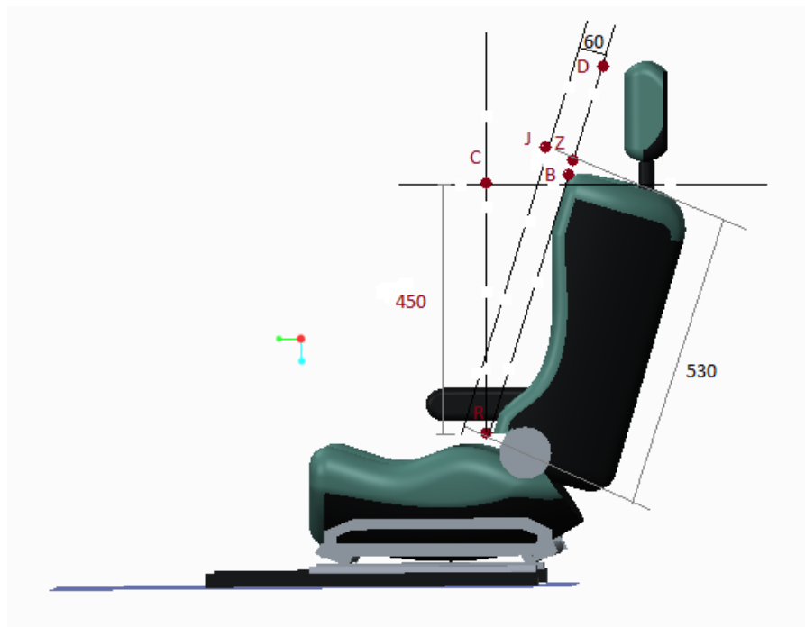
Εικόνα 5.2. Στην εικόνα φαίνεται η τοποθέτηση των σημείων J,Z,B και D σύμφωνα με τη διαδικασία που περιγράφηκε στο στάδιο 2.
