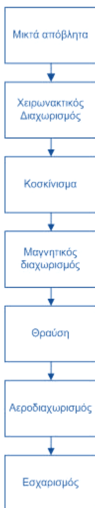
Σχήμα 5.2.: Διαδικασία επεξεργασίας ΑΕΚΚ (ΕΕΔΣΑ, 2010)
