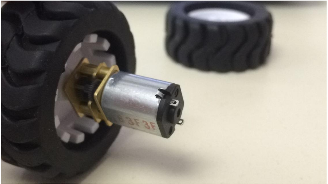
Σχήμα 5.1: Τοποθέτηση κινητήρων στις ειδικά σχεδιασμένες υποδοχές των τροχών
