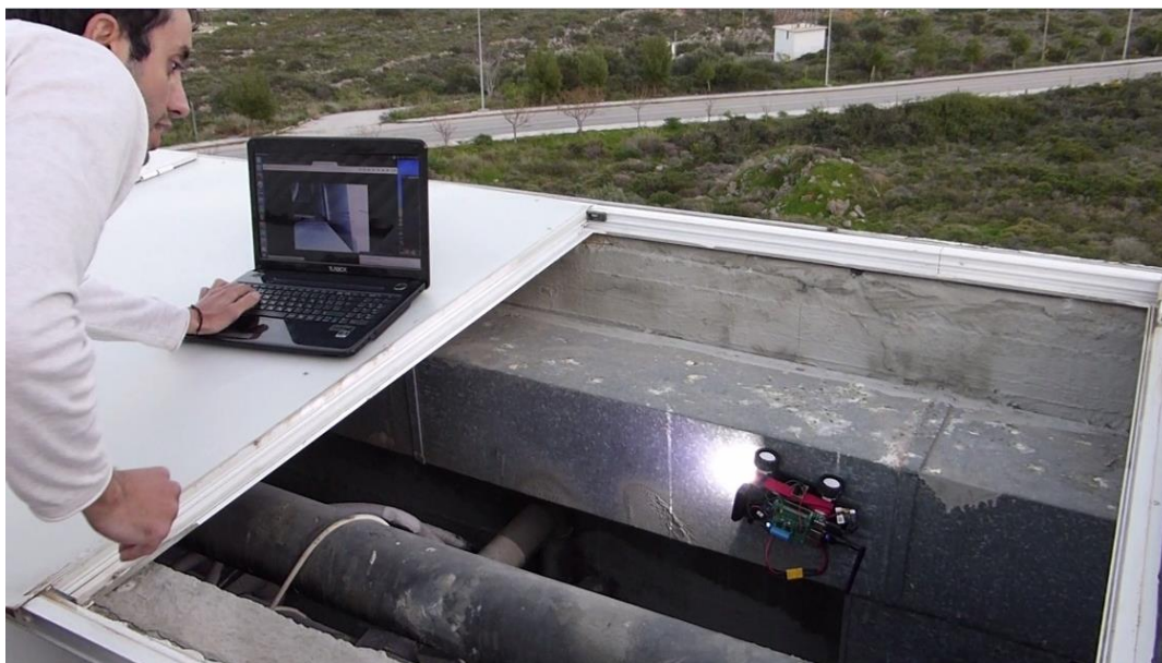
Σχήμα 7.4: Ζωντανή μετάδοση εικόνας από την κάμερα του ρομποτικού συστήματος
