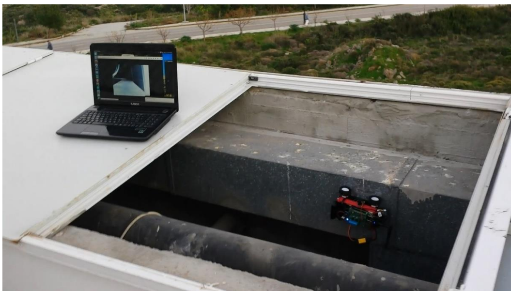
Σχήμα 7.2: Τοποθέτηση ρομποτικού οχήματος σε πλαϊνή μεταλλική επιφάνεια με σκοπό την εξωτερική επιθεώρηση αγωγών
