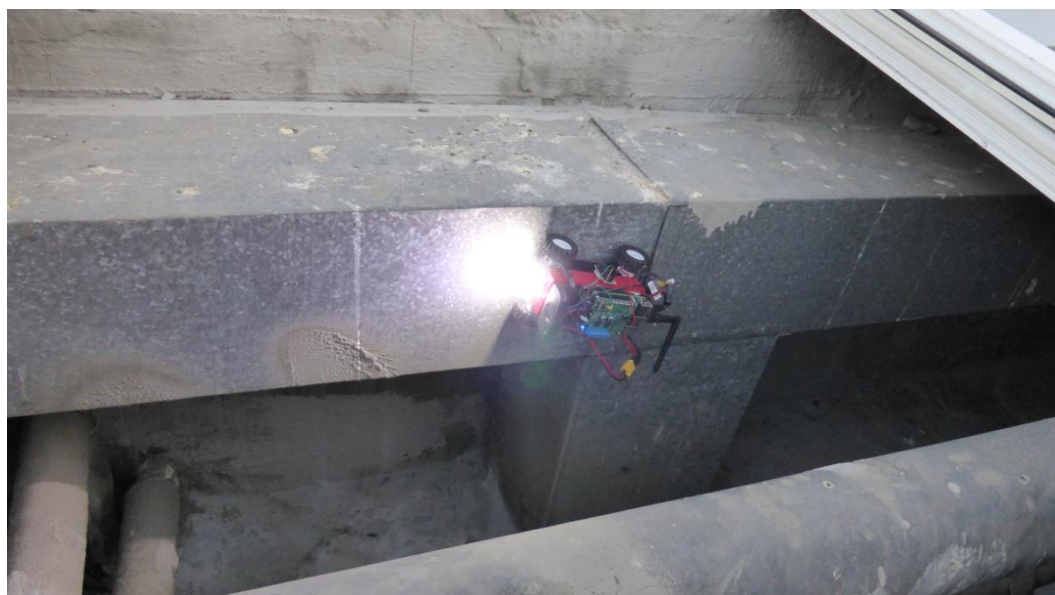
Σχήμα 7.3: Ενεργοποίηση συστήματος φωτισμού για την καλύτερη απόδοση εικόνας
