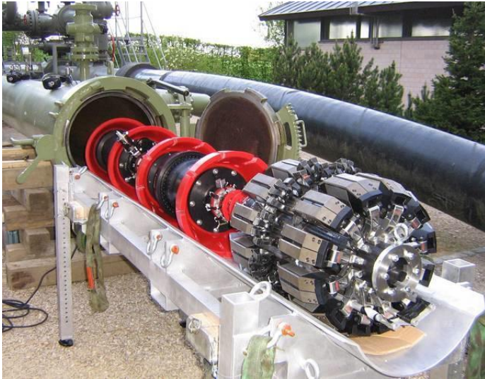
Σχήμα 2.3: Συσκευές καθαρισμού και συντήρησης αγωγών (Pigs) [Link 19]
