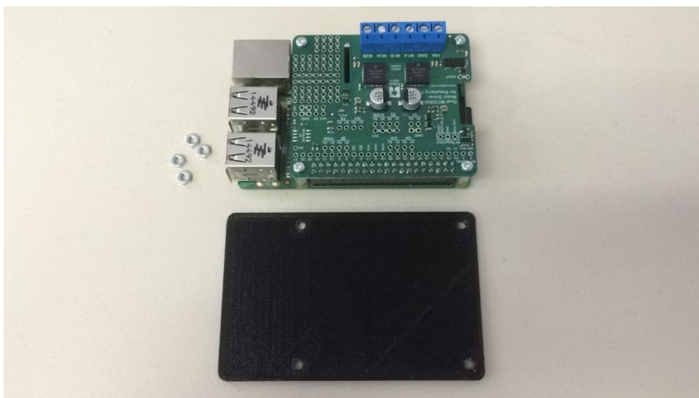
Σχήμα 5.6: Προσθήκης ειδικά σχεδιασμένης βάσης στο ολοκληρωμένο σύστημα
