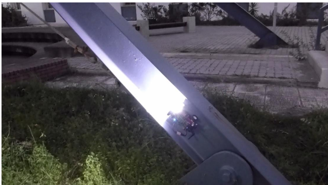
Σχήμα 7.9: Ανάβαση ρομποτικού οχήματος σε εξωτερική μεταλλική κατασκευή
