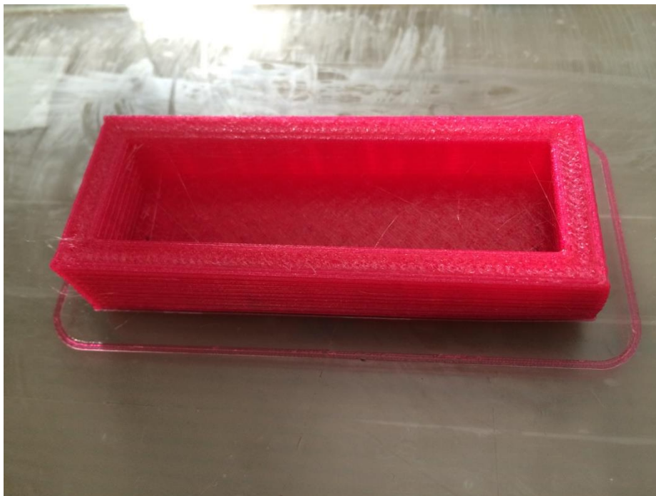
Σχήμα 4.13: Ολοκλήρωση τρισδιάστατης εκτύπωσης της βάσης ένωσης
