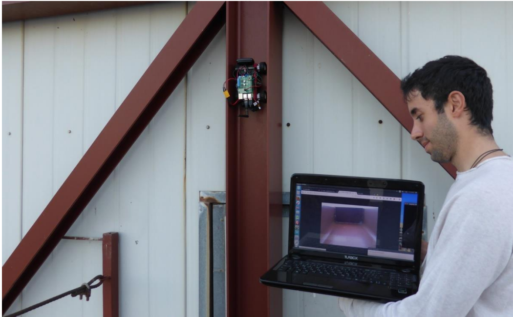
Σχήμα 7.12: Ανάβαση ρομποτικού οχήματος σε μεταλλική κατασκευή με παράλληλη ζωντανή μετάδοση εικόνας σε Ηλεκτρονικό Υπολογιστή
