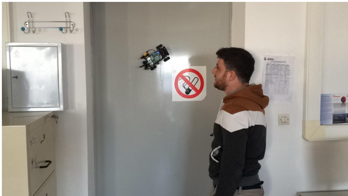
Σχήμα 7.1: Ανάβαση ρομποτικού οχήματος σε κάθετη μεταλλική επιφάνεια
