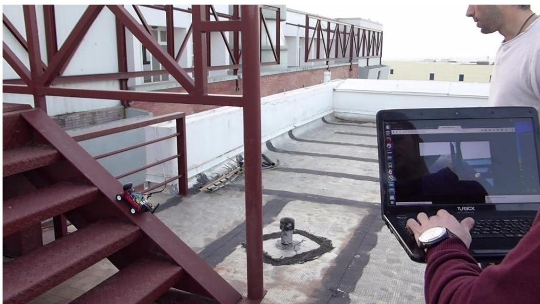
Σχήμα 7.15: Ανάβαση στενής κεκλιμένης μεταλλικής επιφάνειας
