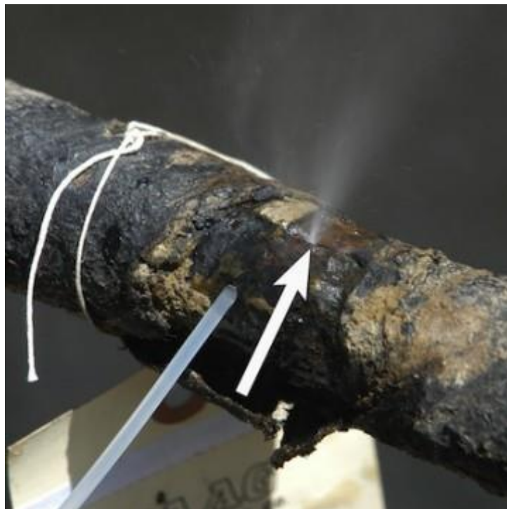
Σχήμα 2.20: Διαρροή Φυσικού Αερίου εξαιτίας κακής συντηρήσεως του αγωγού συστήματος μεταφοράς αυτού [Link 24]
