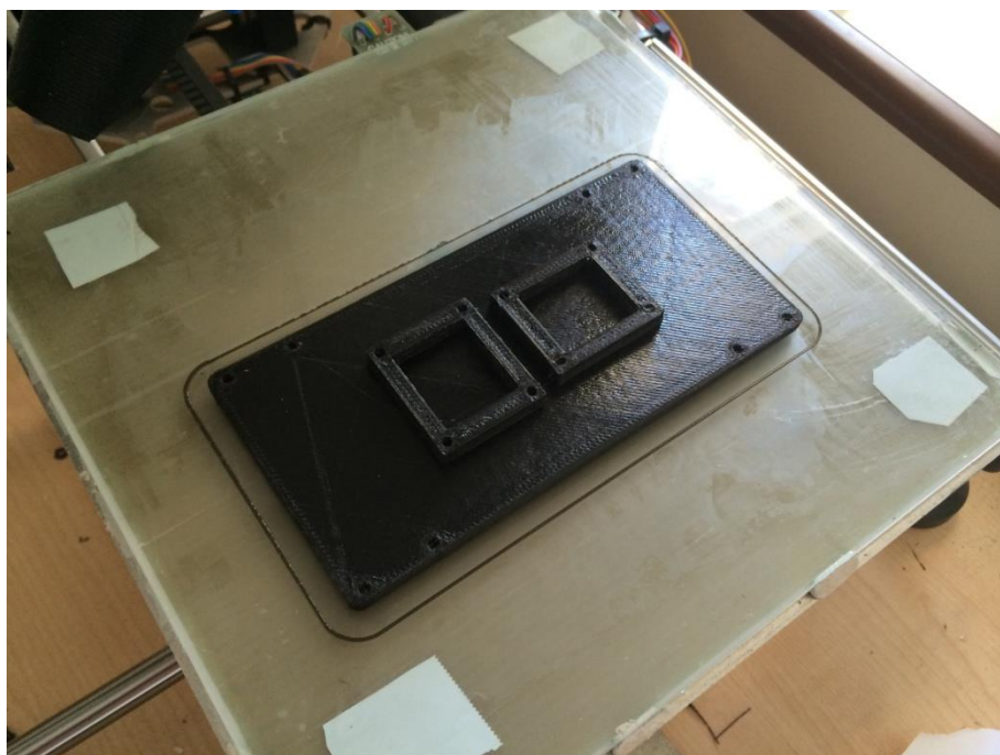
Σχήμα 4.10 : Ολοκλήρωση τρισδιάστατης εκτύπωσης βασικού σκελετού οχήματος
