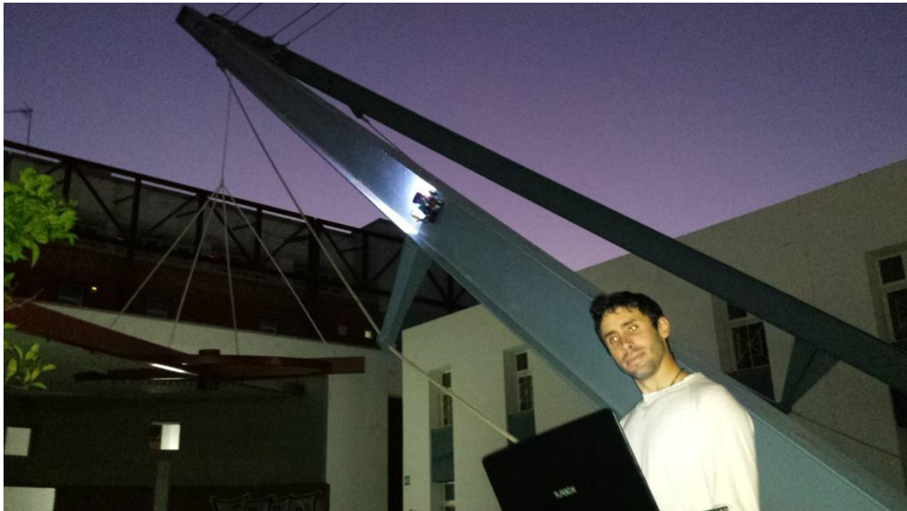
Σχήμα 8.7: Πλάγια ανάβαση του μη επανδρωμένου οχήματος σε μεταλλική επιφάνεια
