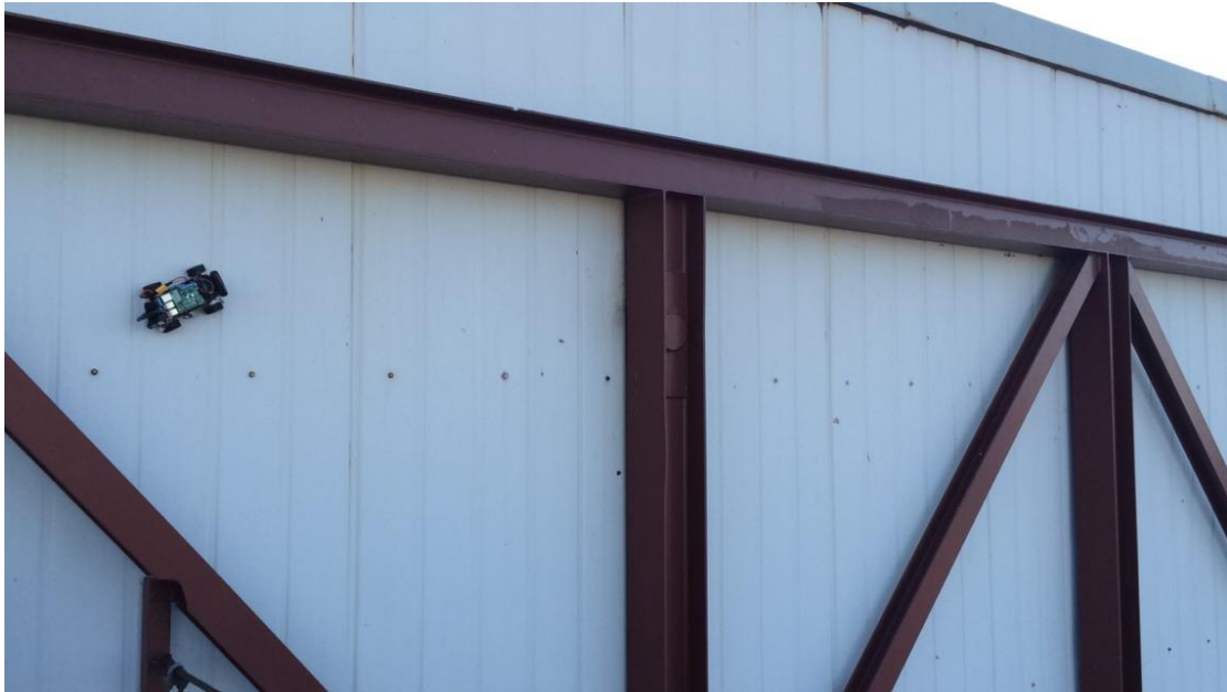
Σχήμα 7.14: Κίνηση ρομποτικού οχήματος στην μεταλλική πρόσοψη του κτηρίου
