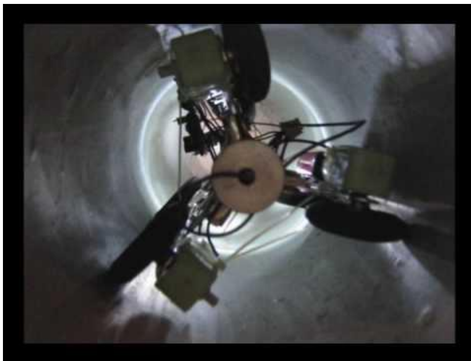
Σχήμα 2.4: Pipeline Inspection Robot με μηχανικά ορισμένο μεταβλητό μέγεθος δομής ψαλιδιού [Link 20]
