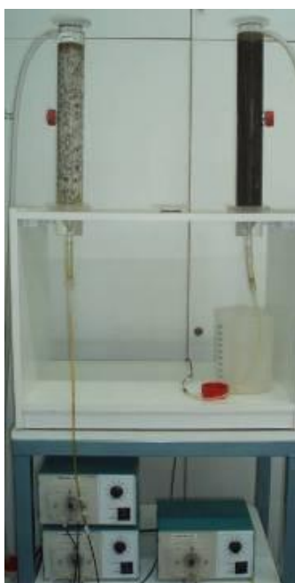
Σχήμα 3.3. Εργαστηριακές στήλες (5 cm εσωτερική διάμετρος και 40 cm ύψος) πληρωμένες με ασβεστόλιθο και κατσικίσια κοπριά (από αριστερά προς δεξιά) στα οποία διέρχεται διάλυμα φαινόλης 100 mg/L, με χρήση περισταλτικών αντλιών
