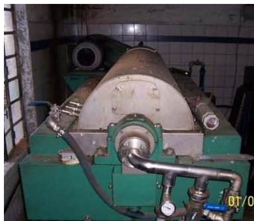
Σχήμα 2.4: Φυγοκεντρικός διαχωριστής (Decanter)
