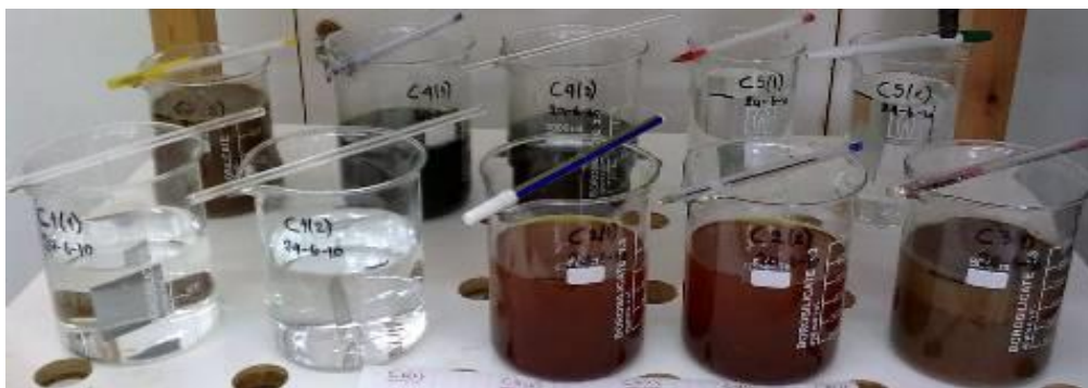
Σχήμα 6. Δοκιμές διάβρωσης χάλυβα σε θερμοκρασία δωματίου (25 °C)
