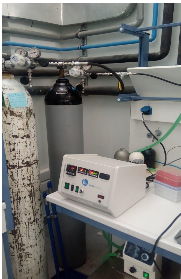
Εικόνα 11: Η συσκευή ελέγχου του αντιδραστήρα και οι φιάλες με την παροχή αέρα και αζώτου
