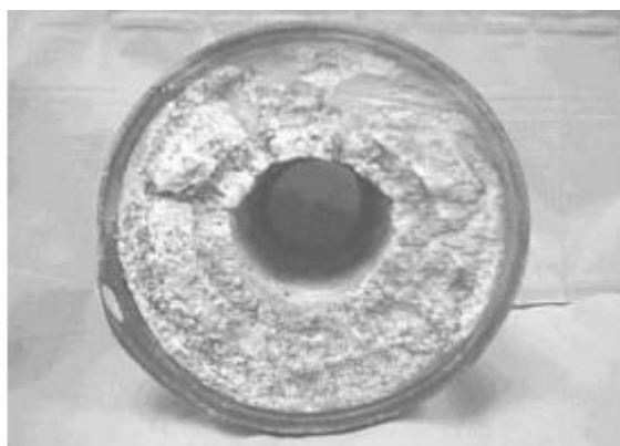
Εικόνα 2: Μείωση διατομής σωλήνα από συσσώρευση στρουβίτη
