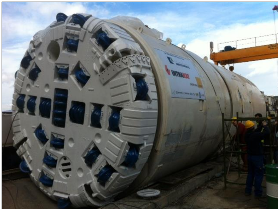
Εικόνα 41: Μηχάνημα ολομέτωπης κοπής T.B.M (αρχεία ΟΑΚ ΑΕ)
