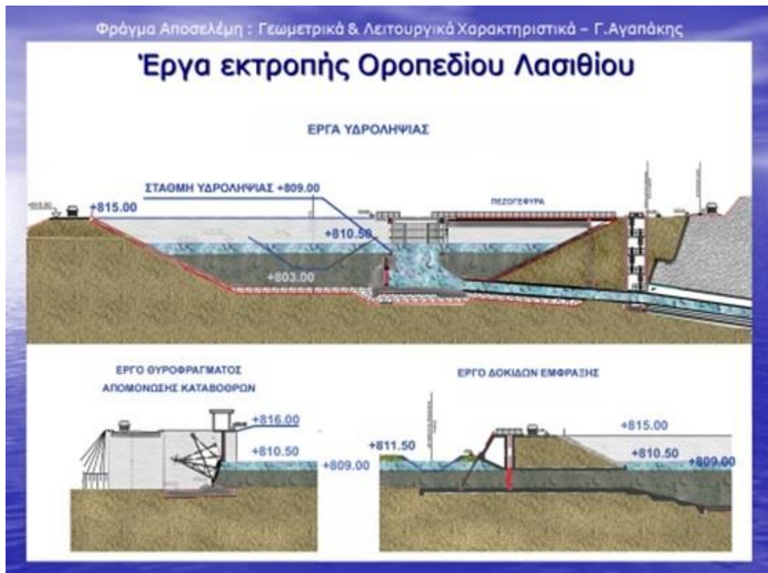
Εικόνα 43: Τομή έργου υδροληψίας (αρχεία ΟΑΚ ΑΕ)
