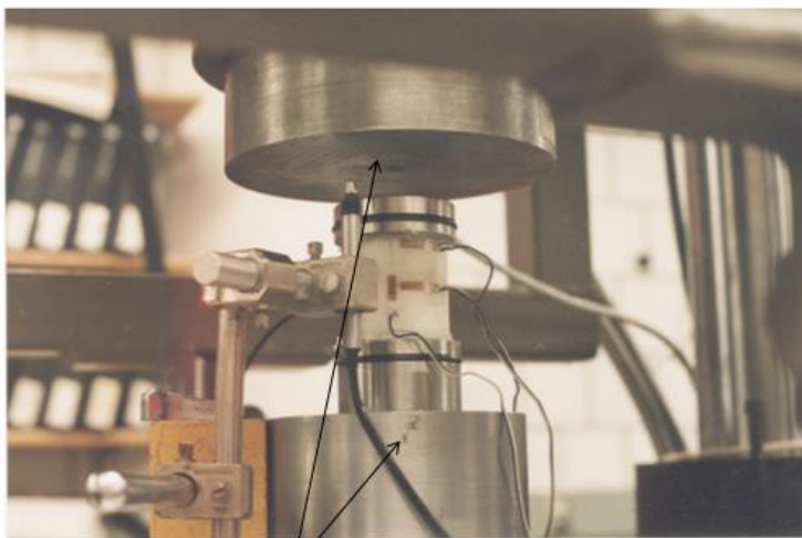
Πλάκες έδρασης Υδραυλική μηχανή θλίψης με δοκίμιο μαρμάρου
